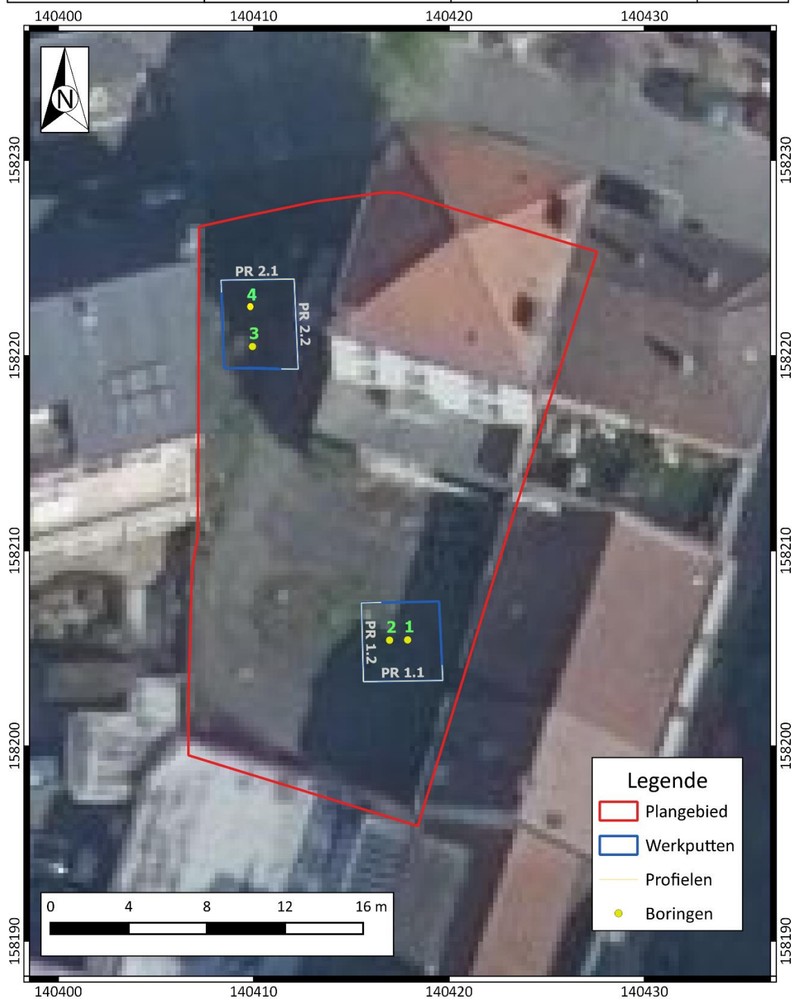
Plan 4: Overzichtskaart van de profielregistraties en boringen, geprojecteerd op de orthofoto 12 (1:1; digitaal; 17092020)
