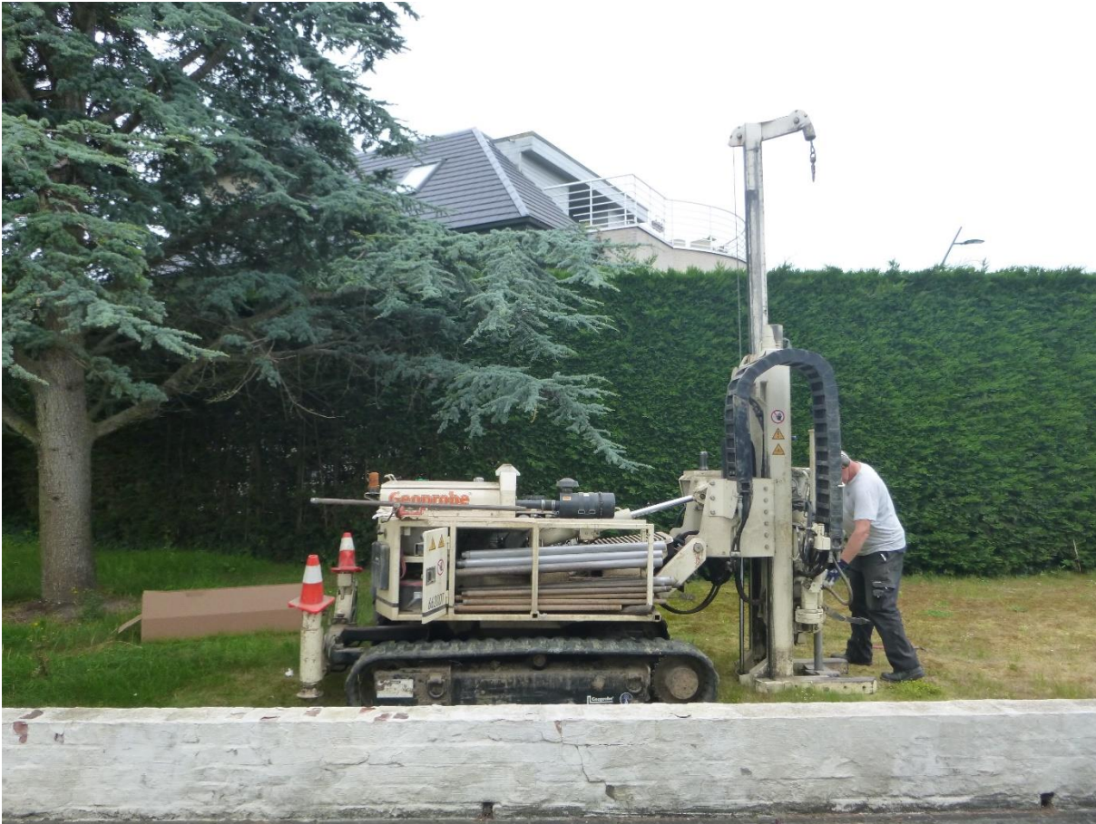
Figuur 37: Geoprobe boormachine, gebruikt voor het uitvoeren van de boringen.
