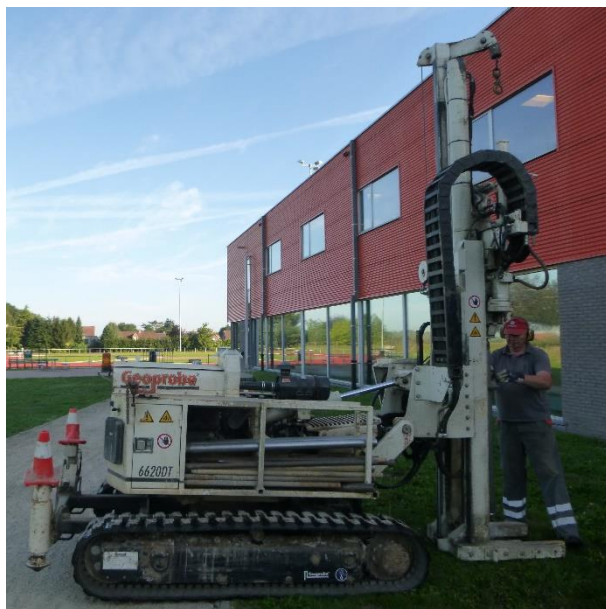
Figuur 3: Zij aanzicht van de Geoprobe boormachine gebruikt tijdens dit booronderzoek.
