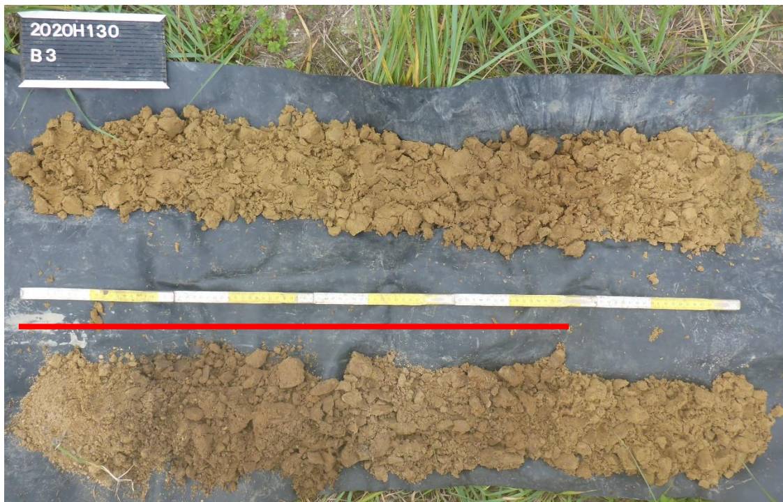
Figuur 28: controleboring 3 (rode lijn geeft het verstoorde deel weer).
