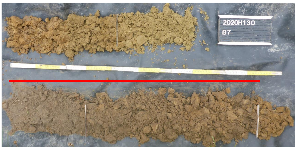
Figuur 32: controleboring 7 (rode lijn geeft het verstoorde deel weer).
