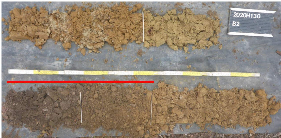
Figuur 27: controleboring 2 (rode lijn geeft het verstoorde deel weer).
