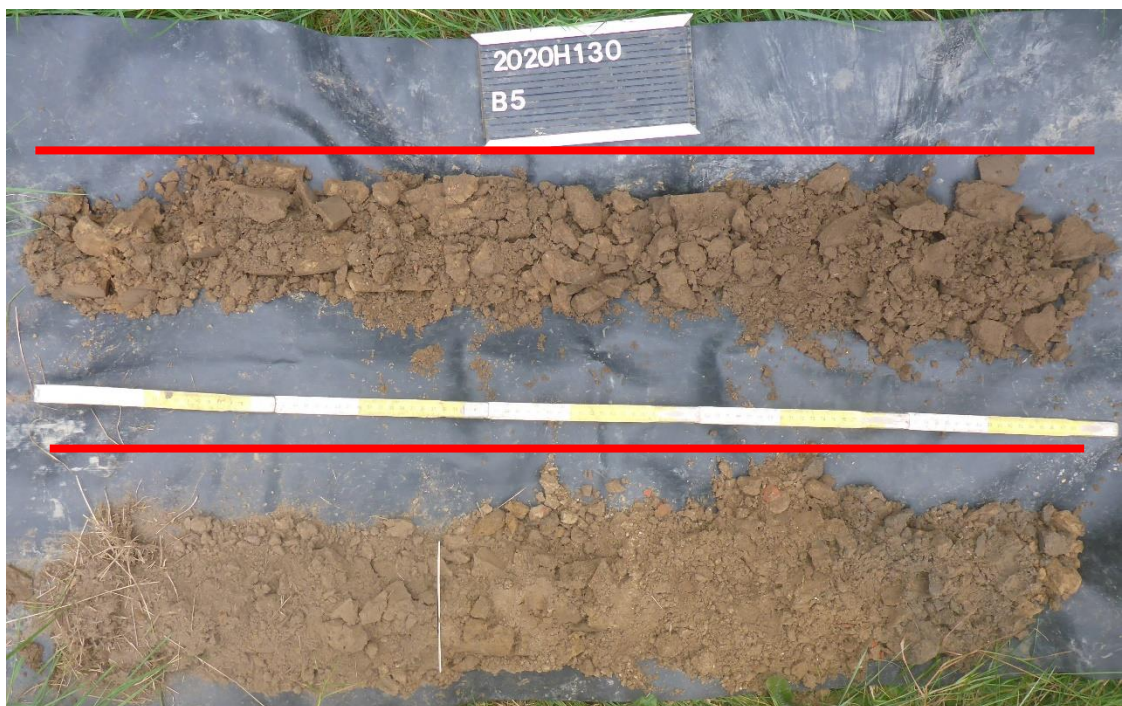
Figuur 30: controleboring 5 (rode lijn geeft het verstoorde deel weer).
