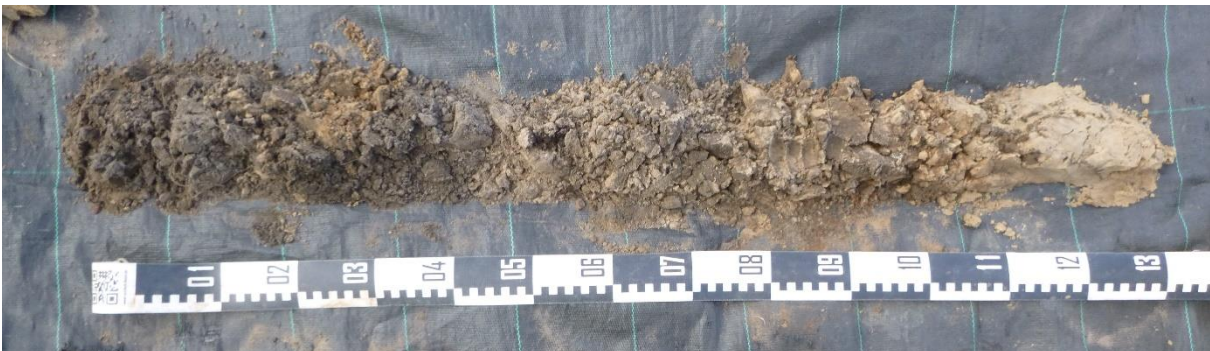
Figuur 19: Overzichtsfoto van BP20 met het AC-bodemprofiel. Het sediment werd uitgelegd van links naar rechts.
