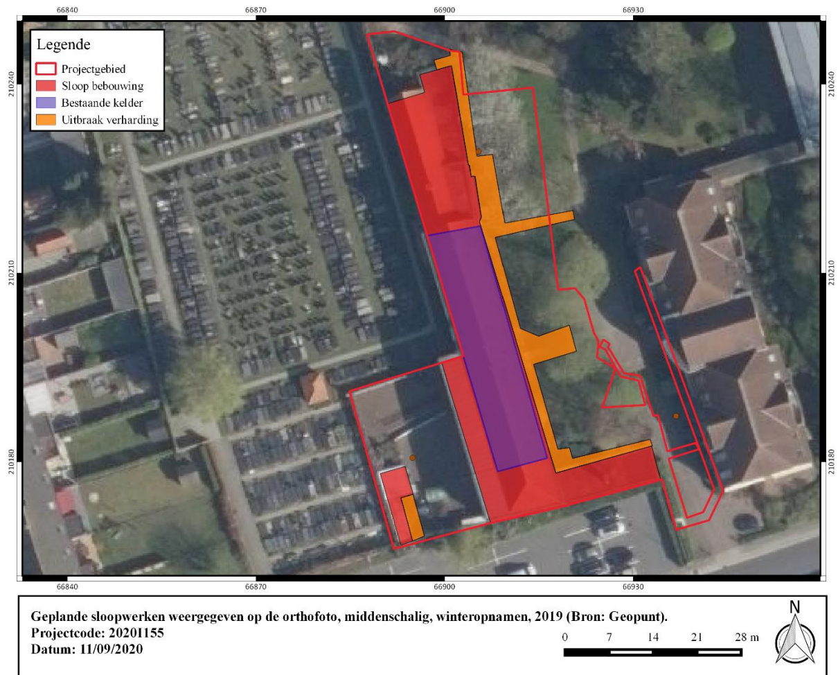
Figuur 5: Geplande sloopwerken weergegeven op de orthofoto, middenschalg, winteropnamen, 2019 (Bron: Geopunt).
