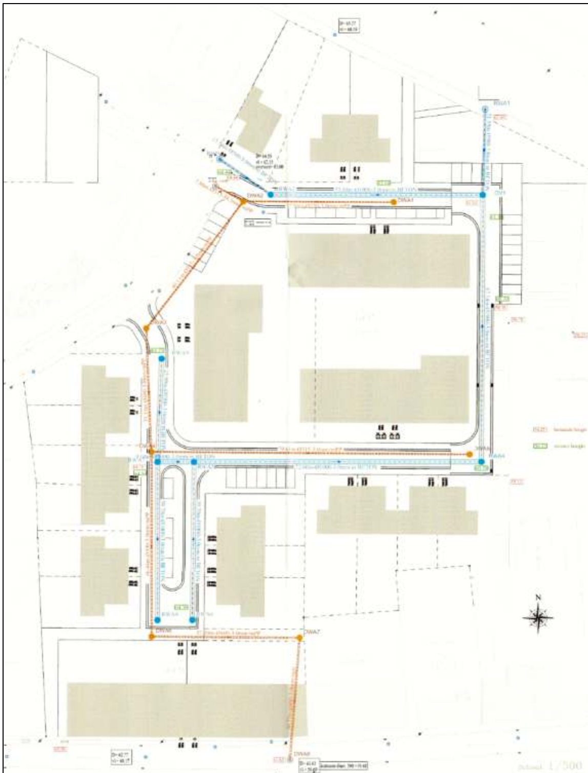
Figuur 4. Plan 28 Ontwerp rioleringen. (Bron: uittreksel uit de plannen van de vergunningsaanvraag).
