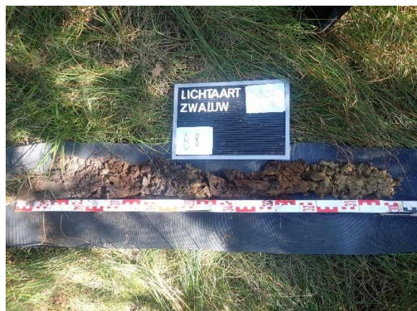
Figuur 7: Typevoorbeeld Boring 8 (Bh-horizont) (© J. Verrijckt Bvba)
