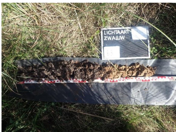
Figuur 8: Typevoorbeeld Boring 3 (A/C-profiel) (© J. Verrijckt Bvba)
