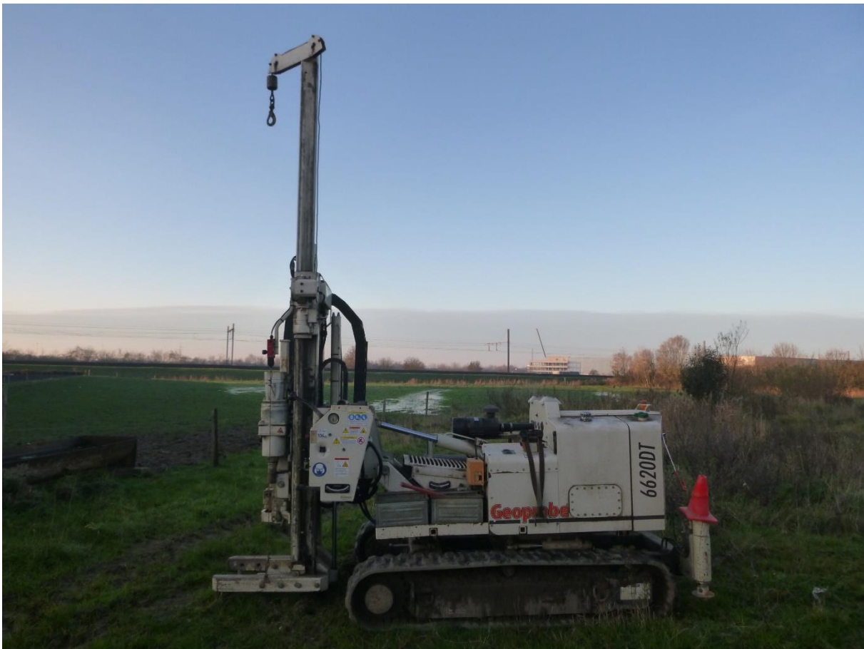
Figuur 3: Zijaanzicht van de Geoprobe boormachine gebruikt tijdens dit landschappelijk bodemonderzoek.
