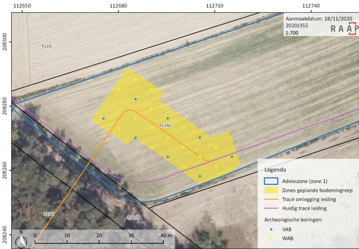
Figuur 5. Projectie van de potentiële verkennende (VAB) en waarderende archeologische boringen (WAB) ter hoogte van de advieszone (bron: AGIV, 2018).
