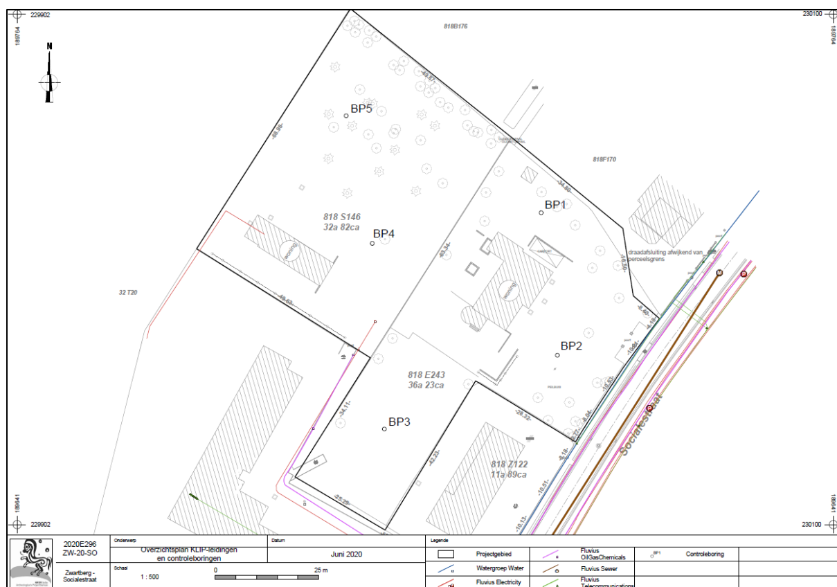
Afb. 30: Overzicht aanwezige nutsleidingen en uitgevoerde controleboringen op het projectgebied (Bron: KLIP, digitaal plan, dd 17/06/2020, aanmaakschaal 1.500, 2020E296).
