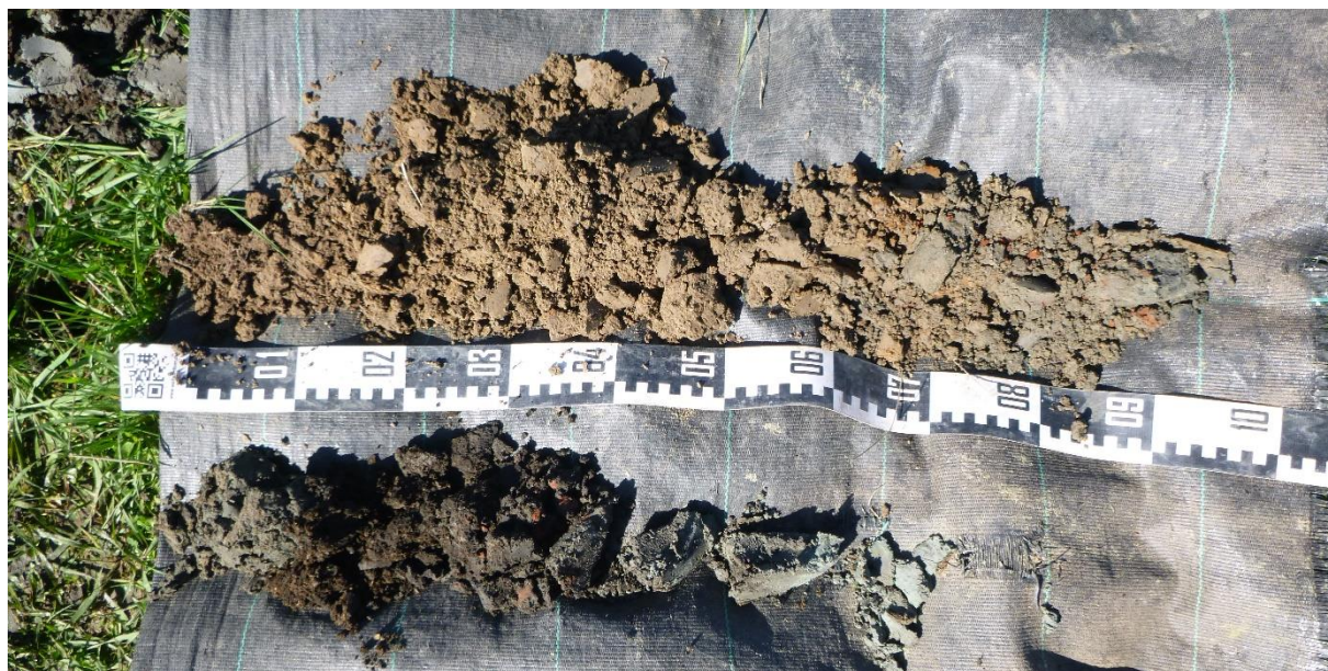
Figuur 39: Overzichtsfoto van boring BP9, uitgelegd van links naar rechts en van boven naar onder.
