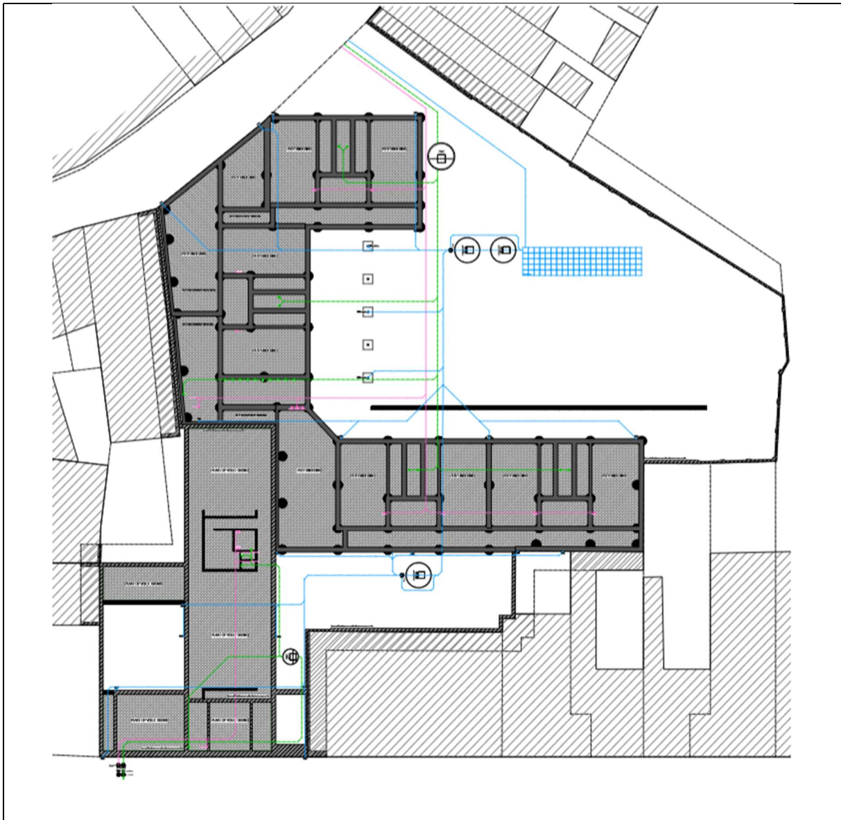
Figuur 6. Fundering- en rioleringsplan van de nieuwbouw.
