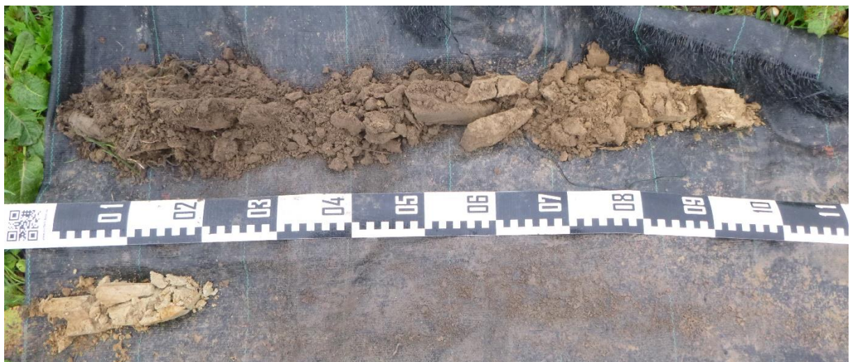
Figuur 8: Overzichtsfoto van boring BP2, uitgelegd van links naar rechts en van boven naar onder.
