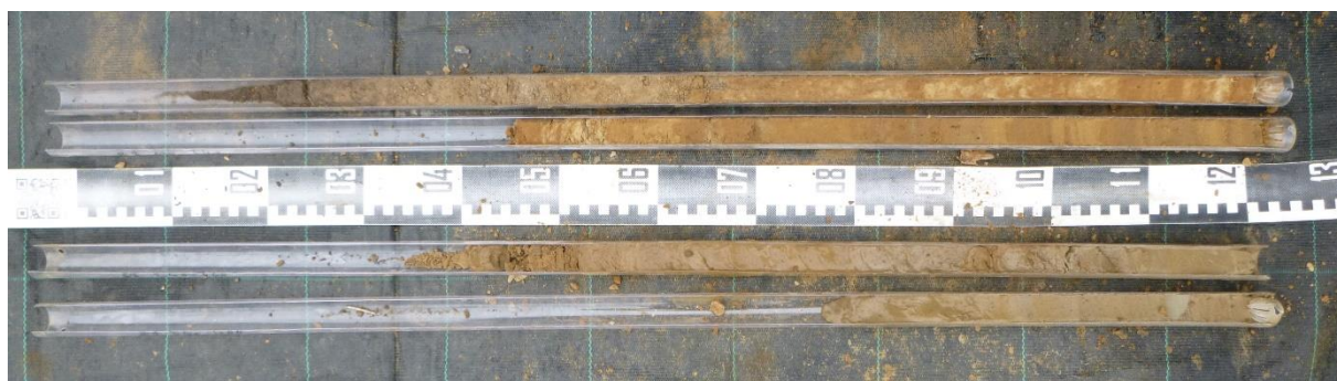
Figuur 41: Overzichtsfoto van boring BP6, uitgelegd van links naar rechts en van boven naar onder. Deze foto is representatief voor boringen BP6, BP9 en BP11.
