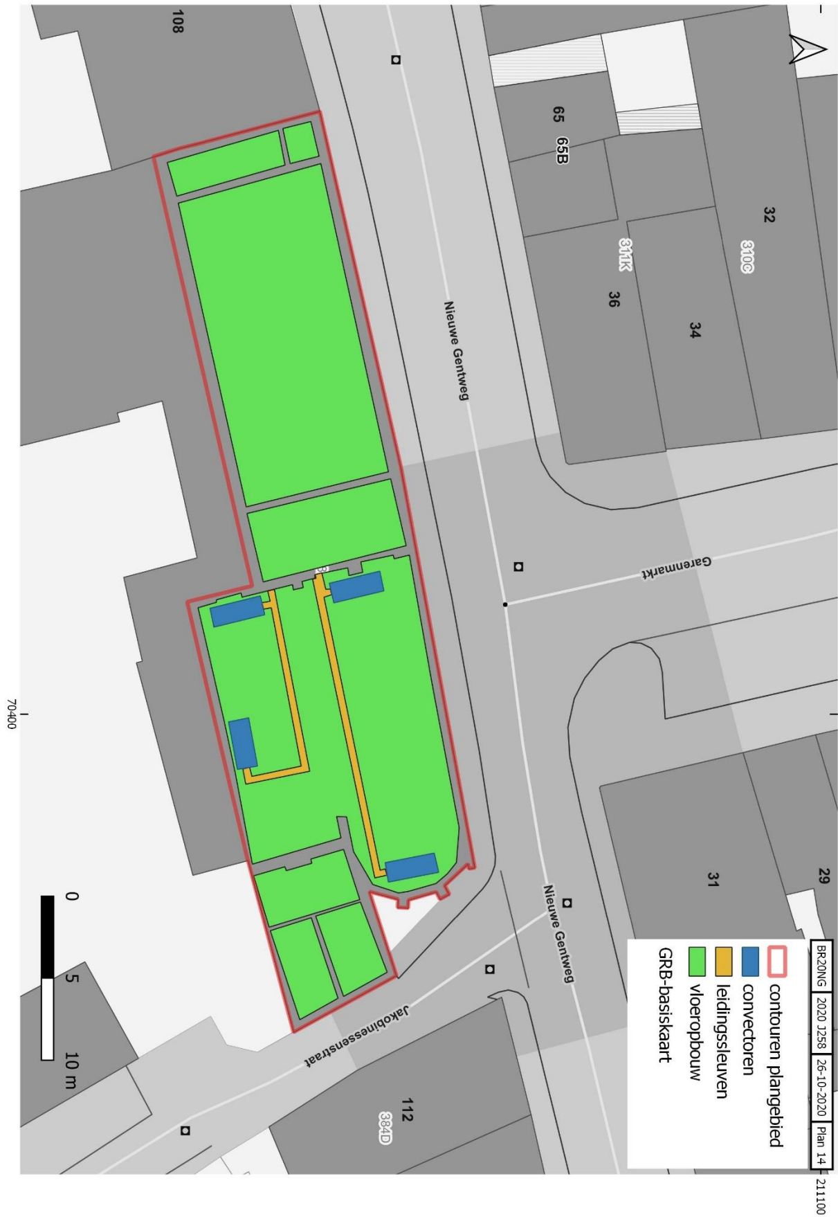
Figuur 4: Plan met aanduiding van de relevante zones voor werfbegeleiding (groene polygonen) t.o.v. het GRB
