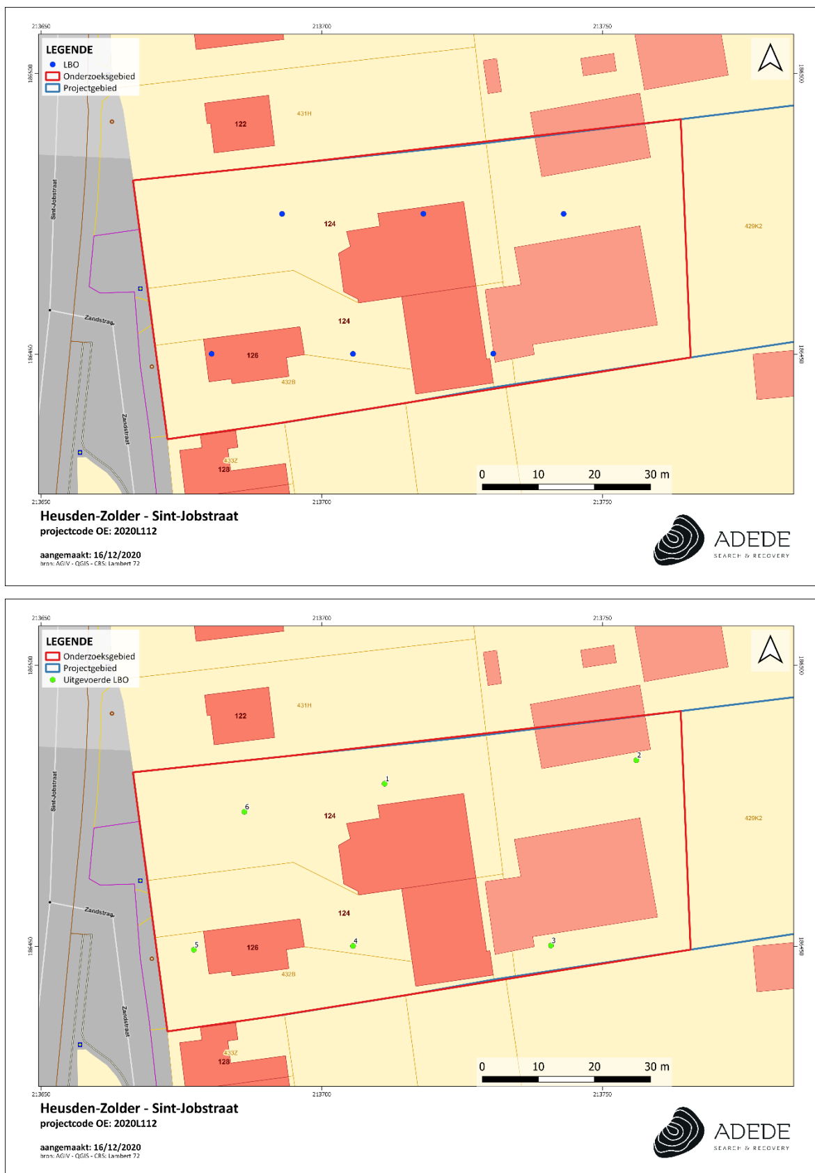
Figuur 4. GRB plan van de landschappelijke boringen zoals gepland (boven) en uitgevoerd (onder).
