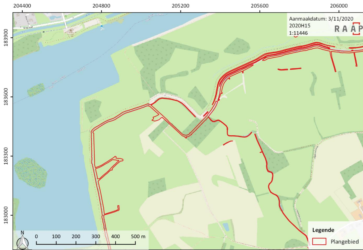
Figuur 13. Deelgebied 2 met aanduiding van de beschreven werken. A. Verleggen loop Oude Herk; B: Wandelbrug; C: verbreding bestaande greppel; D. herprofilering van huidige bedding; E: heraanleg van taluds.
