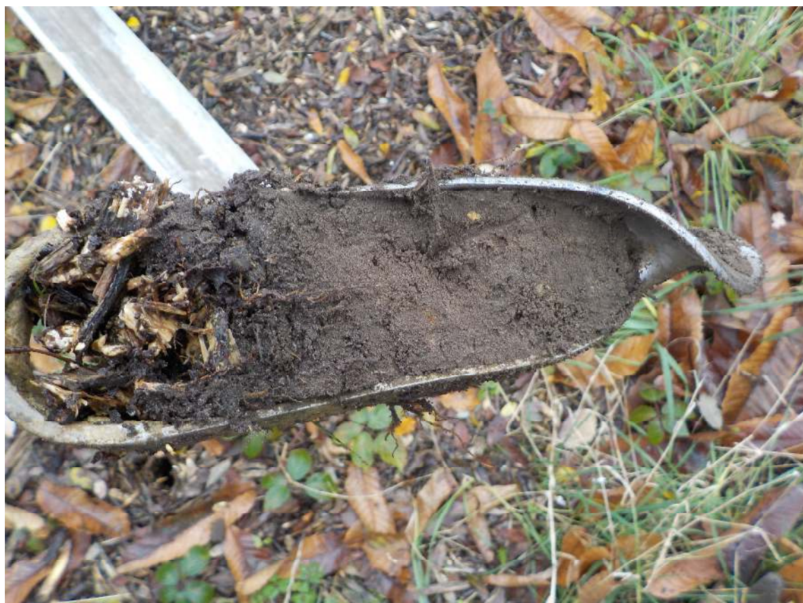
Afbeelding 4.1.1: De eerste 20 cm van de boring 1. Op de foto kan de Ap-horizont herkend worden.
