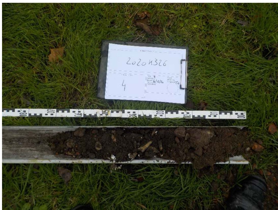
Afbeelding 4.2.2: Uitgelegde bodemopbouw in de hand gegraven put nr. 2.
