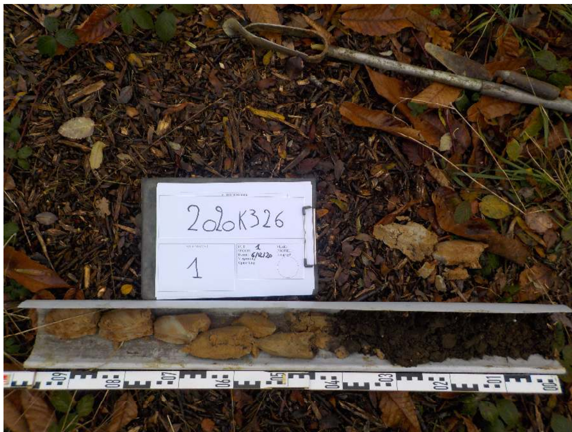
Afbeelding 4.1.3: Overzicht van boring 1 met hierlangs een maatlat gelegen. Het boorresidu van 100 tot 120 cm diepte ligt rechts van het fotobord, langs de goot.
