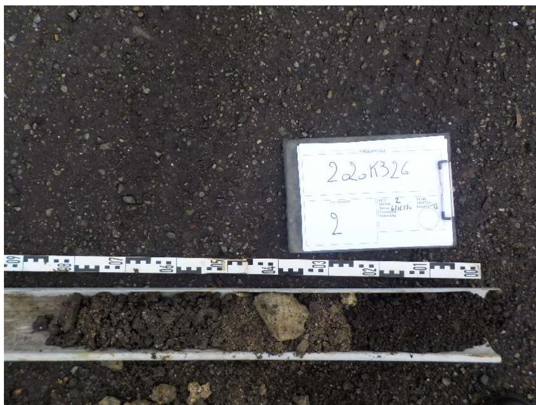
Afbeelding 4.2.2: Uitgelegde bodemopbouw in de hand gegraven put nr. 2.
