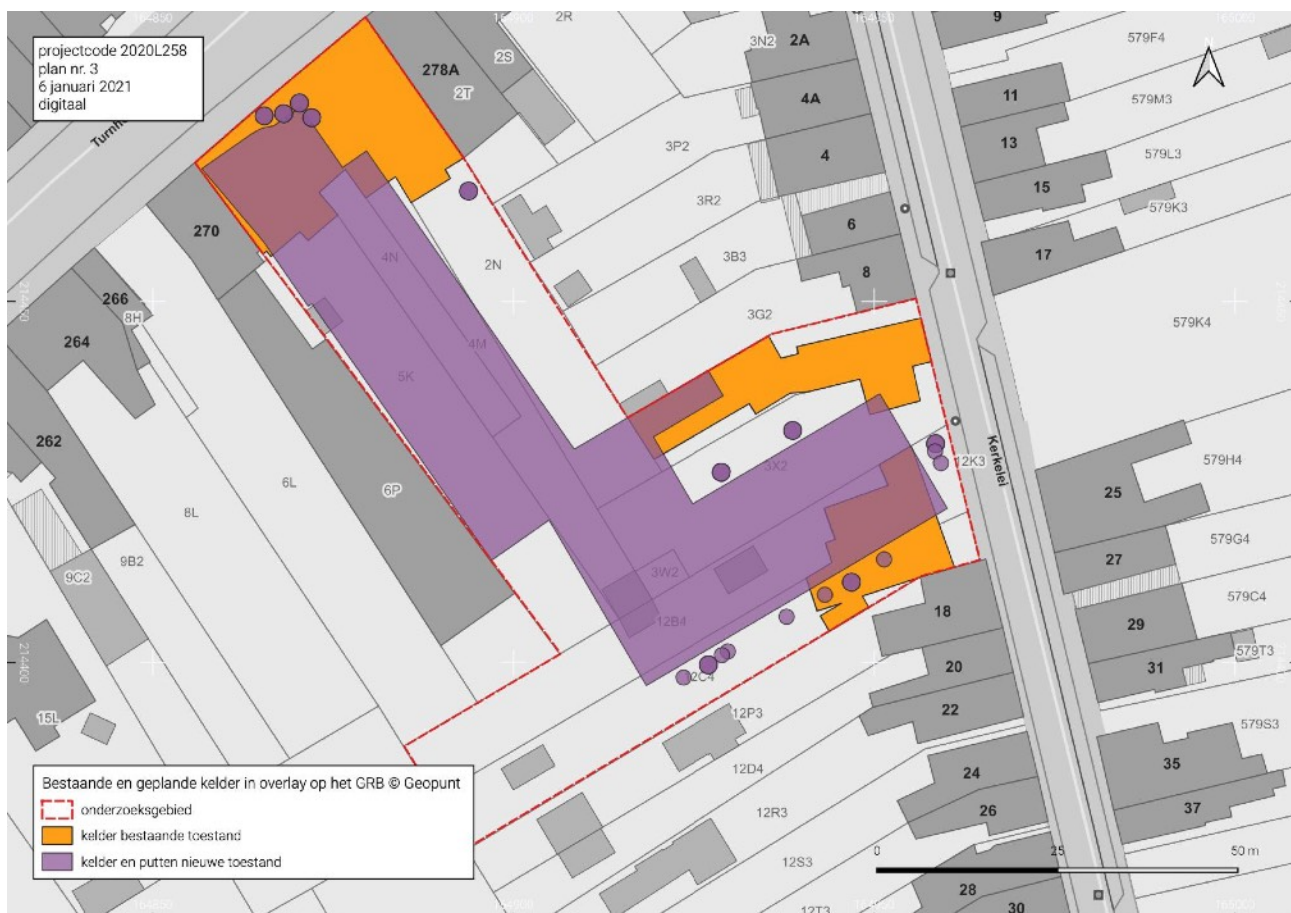
Fig. 6 Kelders bestaande en geplande toestand in overlay op het GRB. © Geopunt & fodio
