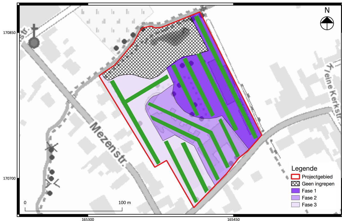
Fig. 2.5: Voorstel inplanting proefsleuven.
