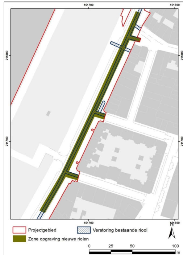
Figuur 5: De zone van de nieuwe rioolsleuven waar een opgraving moet plaatsvinden met de projectie van de verwachte verstoring door het bestaande riool (bron: AGIV/stad Antwerpen dienst Archeologie)
