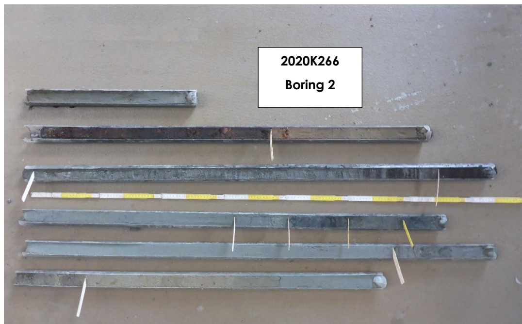
Figuur 49: Boring 2; De top van de profielsequentie bevindt zich onderaan links. Elke liner vertegenwoordigt een lengte van 1.5 m, waarbij enige compactie mogelijk is. Enkel de laatste liner (bovenaan) heeft een lengte van 0.5 m.
