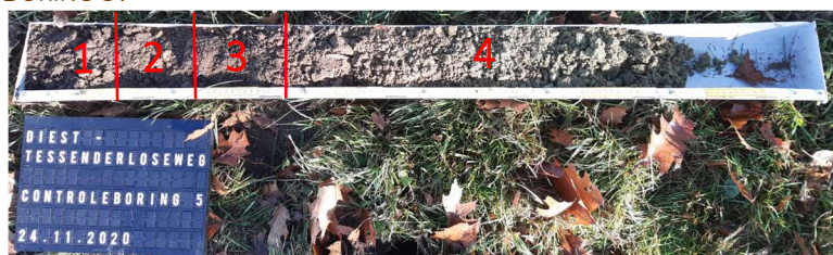
Foto 13: boring 5 op weiland
