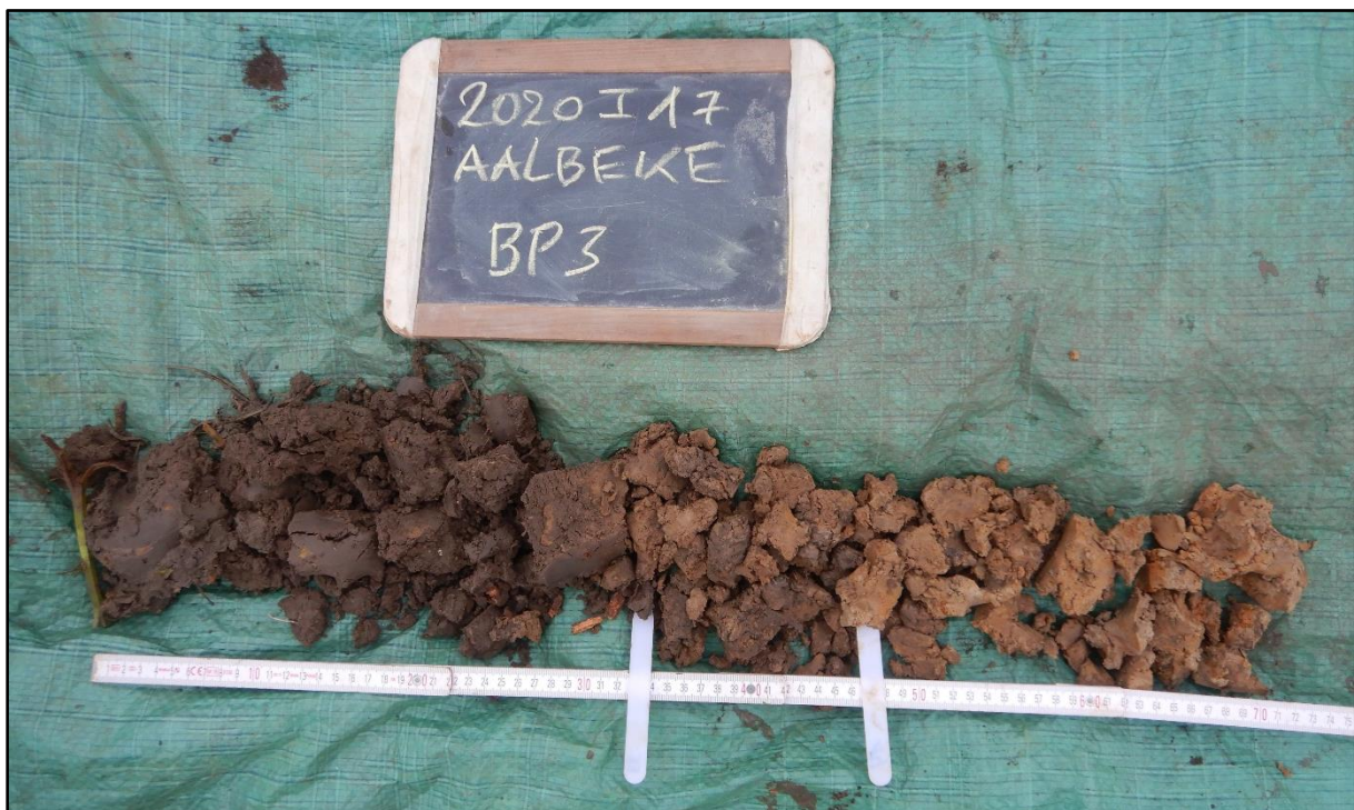
Figuur 11 Zicht op boorprofiel 3 met A(p) – AC – C profiel.
