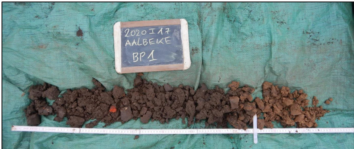
Figuur 9 Zicht op boorprofiel 1 met verstoorde A(p) – C profiel.
