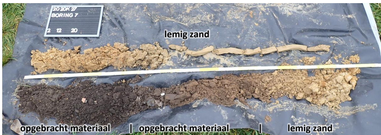
Figuur 3: Foto van boring 7. De top ligt links onder, diepte neemt in elke 'kolom' toe naar rechts.
