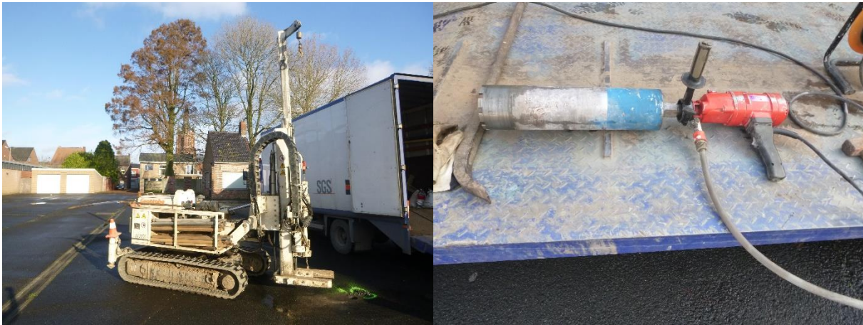
Figuur 30: Zijaanzicht van de Geoprobe boormachine (links) en kernboor (rechts) die gebruikt werden tijdens dit booronderzoek.
