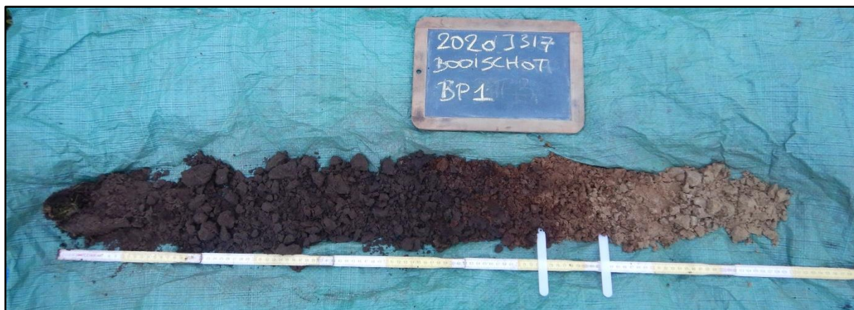
Figuur 11 Zicht op boorprofiel 1 met A(p) – B – C profiel.
