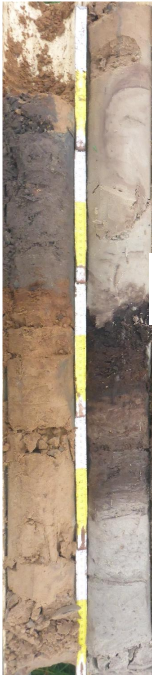
Figuur 59: Boring 143 met begraven venige moerasafzettingen op een diepte van 150 -tot 180 cm t.o.v. het maaiveld (GATE).
