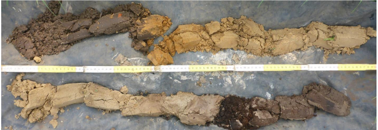
Figuur 27: Boring B166, met een sterk organische paleobodem (i.e. moerasafzetting) (GATE).
