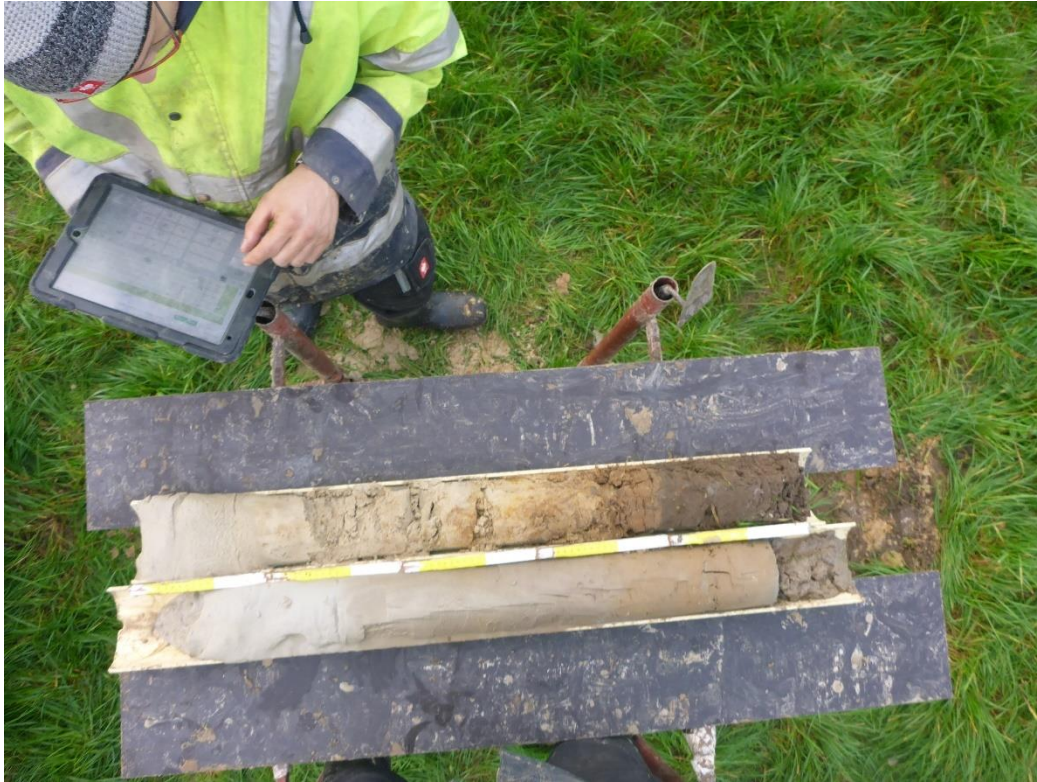
Figuur 47: De beschrijving van het opgeschoonde staal op een tablet (GATE).
