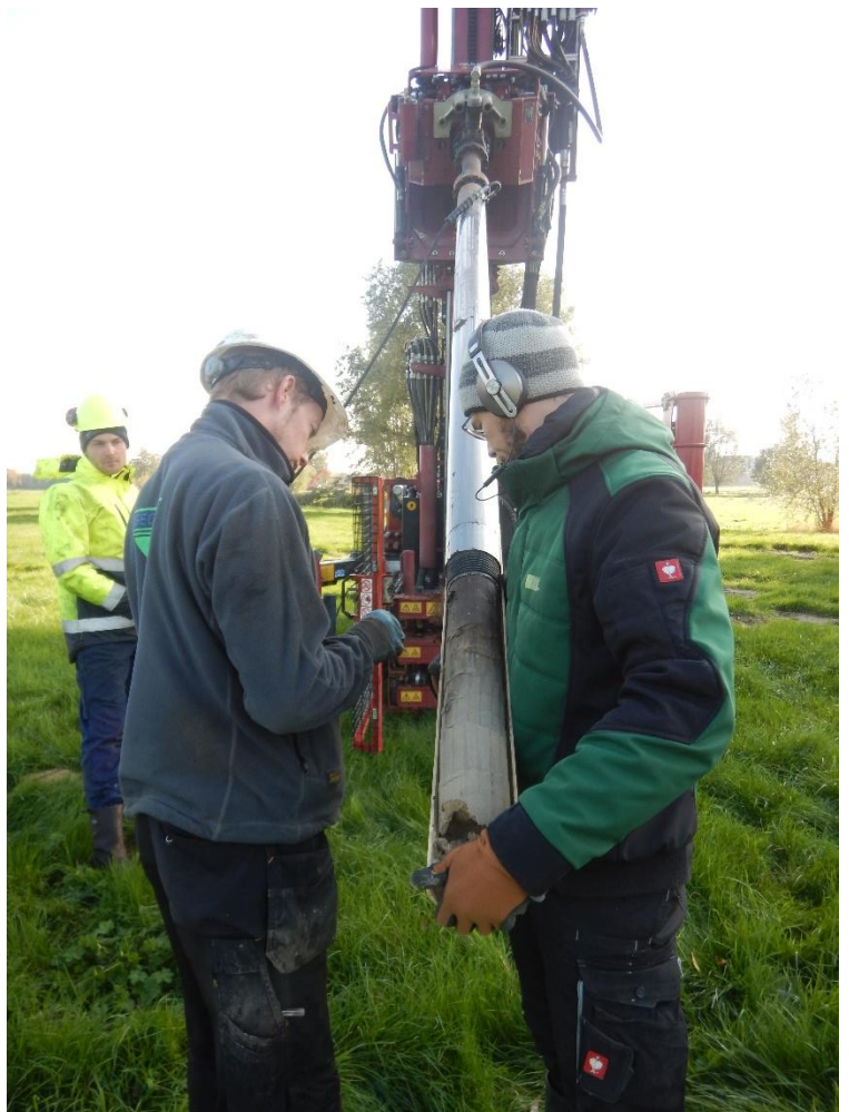
Figuur 46: Het uitduwen van het opgeboorde sediment (GATE).
