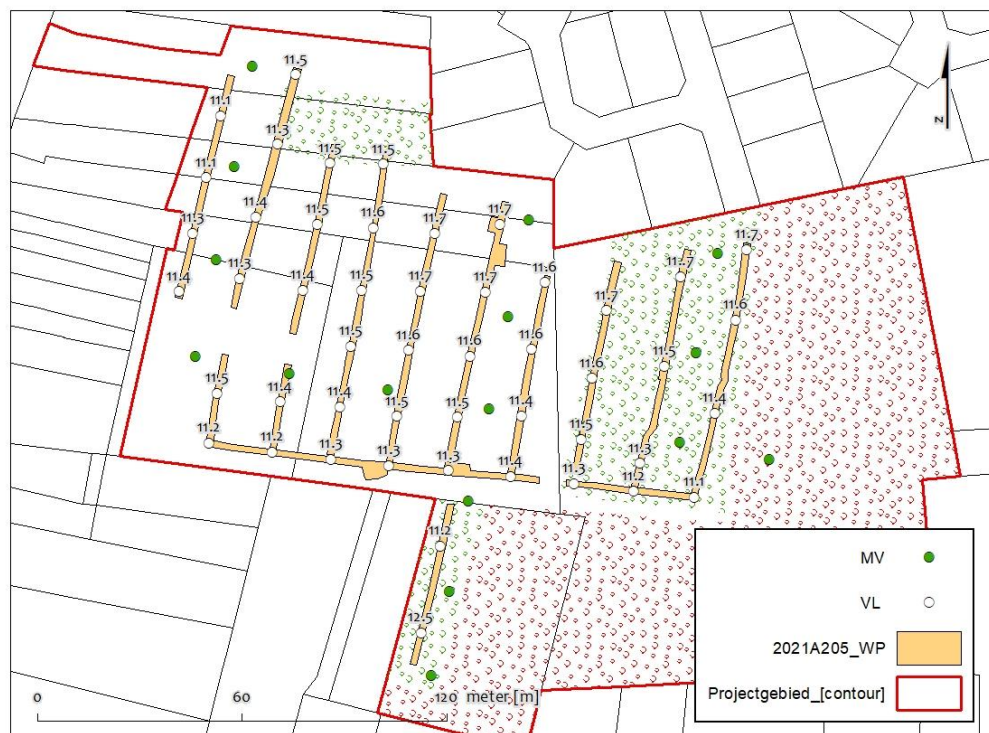
Figuur 12: Niet exhaustief overzicht geregistreerde landschappelijke hoogtes aan het maaiveld uitgedrukt in m TAW (boven); opgemeten hoogtes archeologisch vlak uitgedrukt in m TAW (onder)
