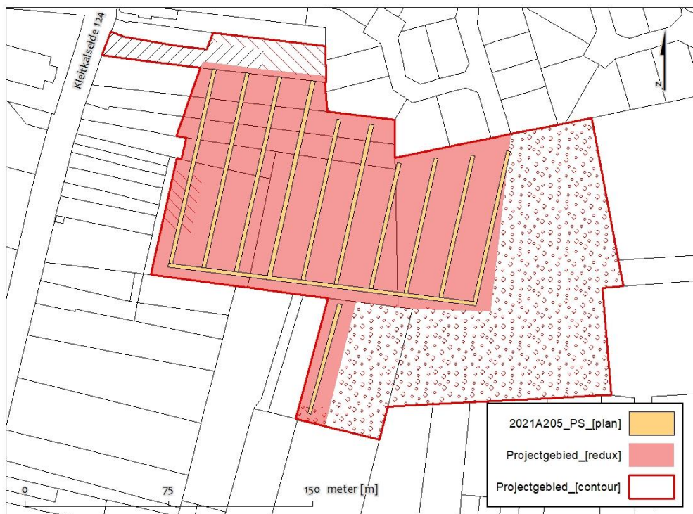
Figuur 9: Voorstel sleuvenplan na afloop LB met aanduiding gereduceerde advieszone
