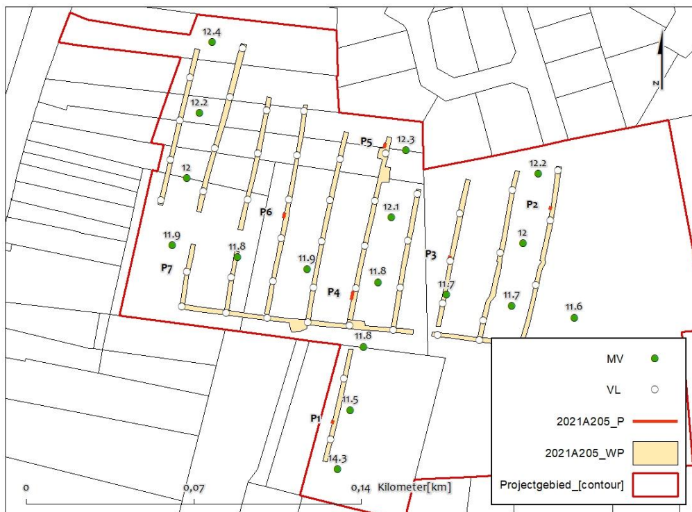
Figuur 14: Overzicht inplanting bodemprofielen met aanduiding maaiveldhoogtes
