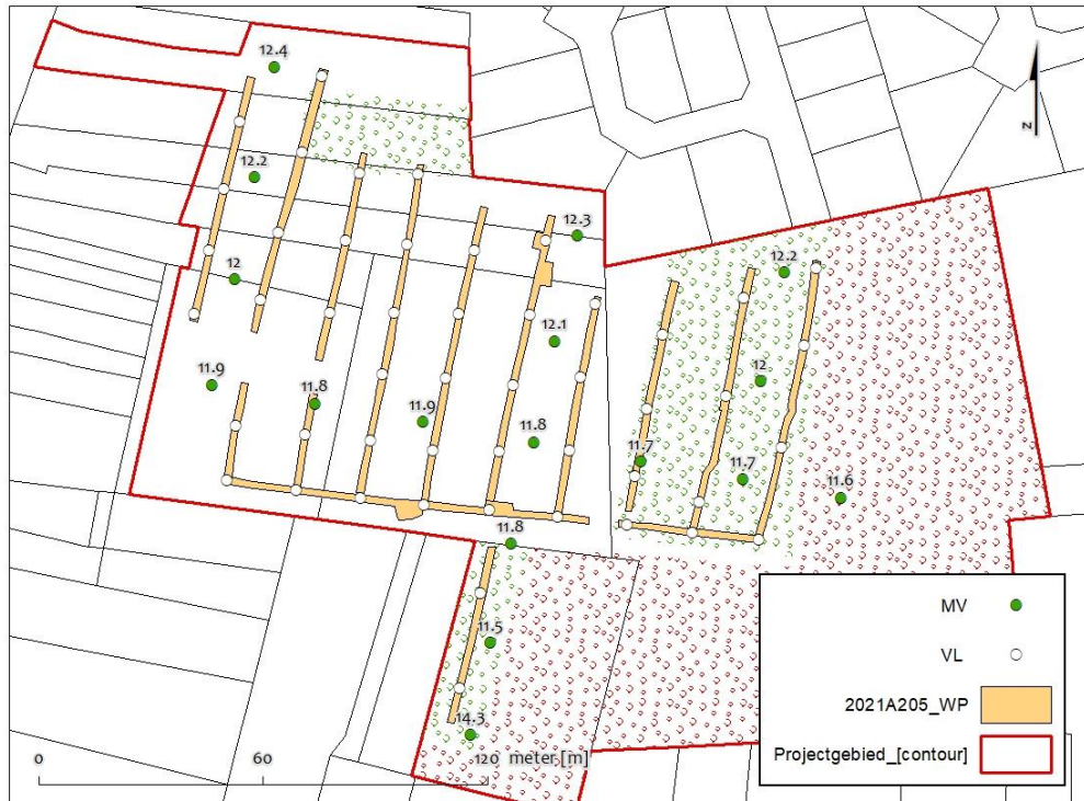
Figuur 12: Niet exhaustief overzicht geregistreerde landschappelijke hoogtes aan het maaiveld uitgedrukt in m TAW (boven); opgemeten hoogtes archeologisch vlak uitgedrukt in m TAW (onder)
