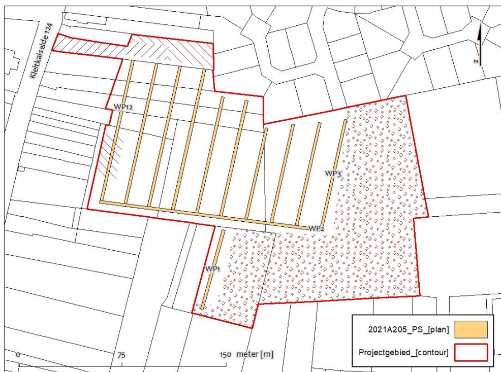
Figuur 8: Voorstel sleuvenplan o.b.v. archeologienota id. 13282 en overleg initiatiefnemer
