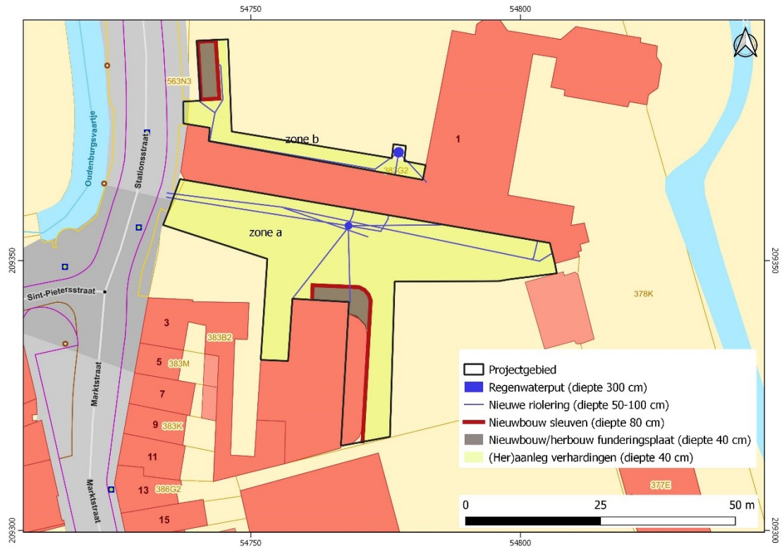
Geschematiseerd ontwerpplan van het projectgebied op basis van informatie aangeleverd door Felix & Partners (basislaag: GRB-kaart van Geopunt 2020).
