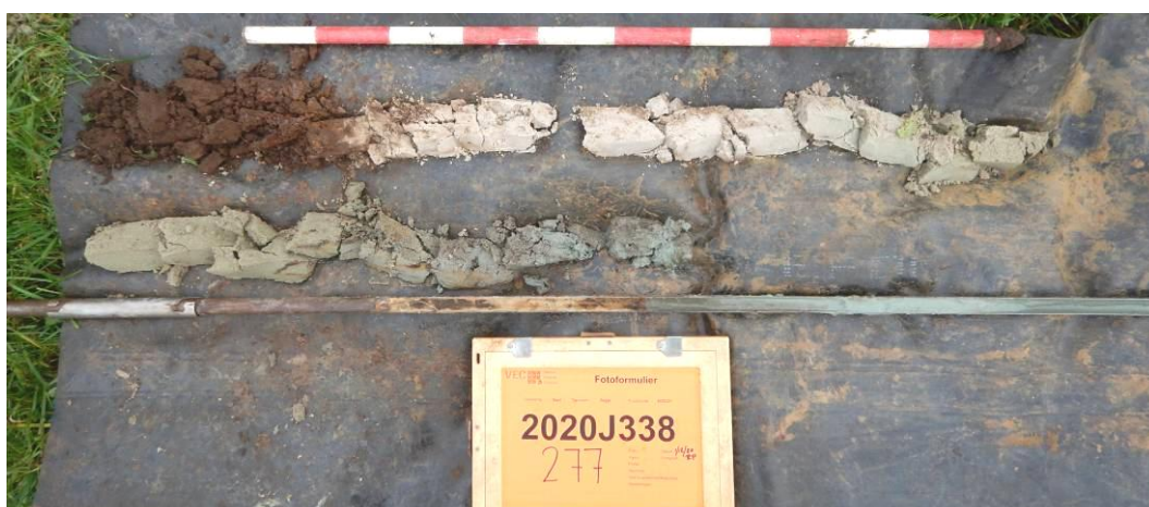
Afb. 36. Foto van boring 277 zonder vegetatielagen maar met humusbrokken aan de basis van de Ap-horizont, uitgelegd per meter van linksboven naar rechtsonder.
