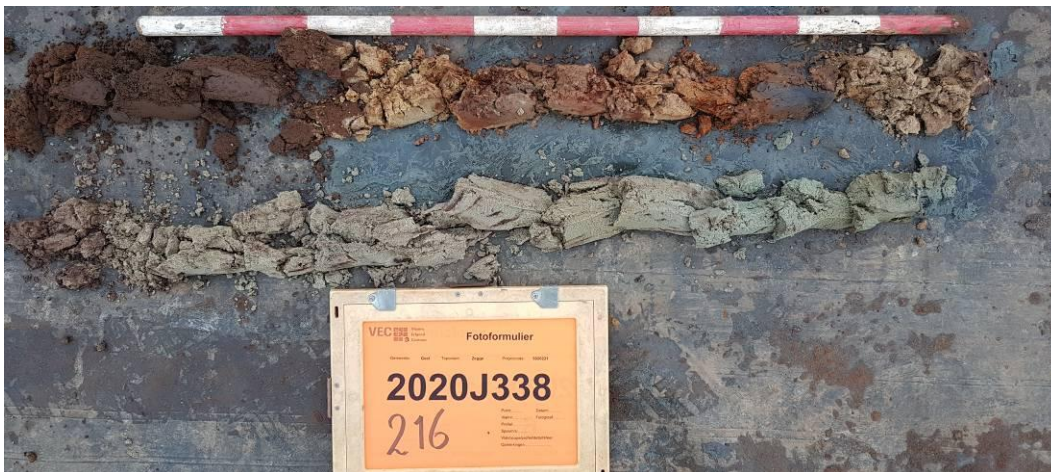
Afb. 38. Foto van boring 216 met donkergrijze zandige klei (vegetatielaag) tussen 75 en 85 cm –mv en houtresten in zand vanaf 110 cm –mv, uitgelegd per meter van linksboven naar rechtsonder.
