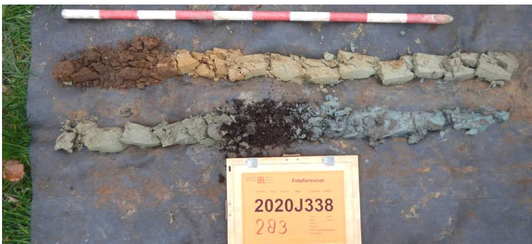
Afb. 27. Foto van boring 283 met veenlaagje tussen de onderliggende blauwgrijze Cr-horizont en de bovenliggende lichtgroene C-horizont, uitgelegd per meter van linksboven naar rechtsonder.
