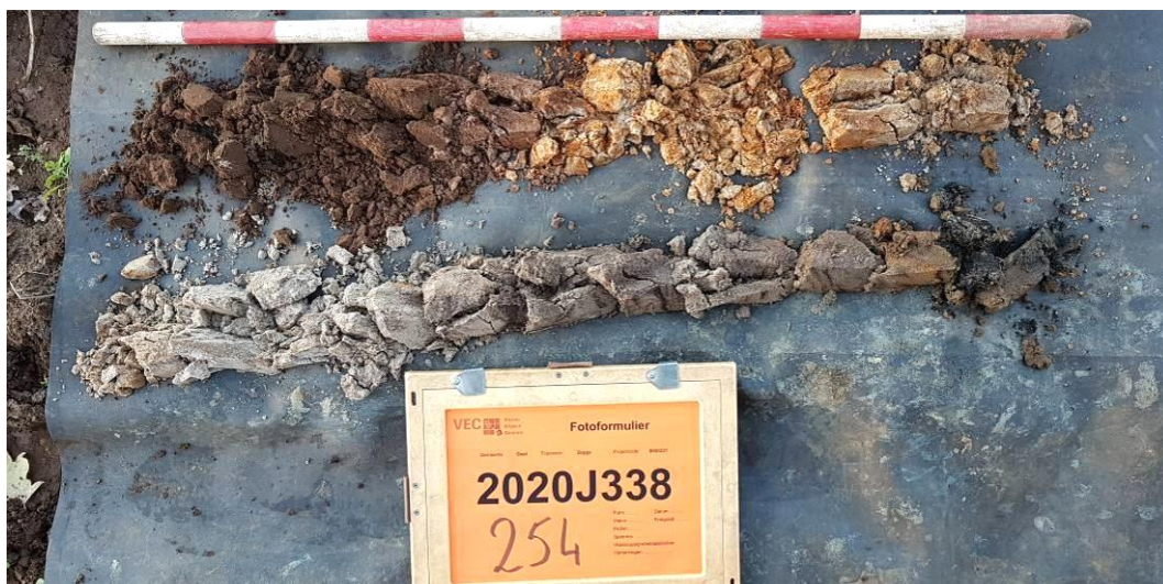
Afb. 29. Foto van boring 254 me veel houtresten aan de basis en sterke afname humusbijmenging vanaf 140 cm –mv en veel houtresten aan de basis, uitgelegd per meter van linksboven naar rechtsonder.
