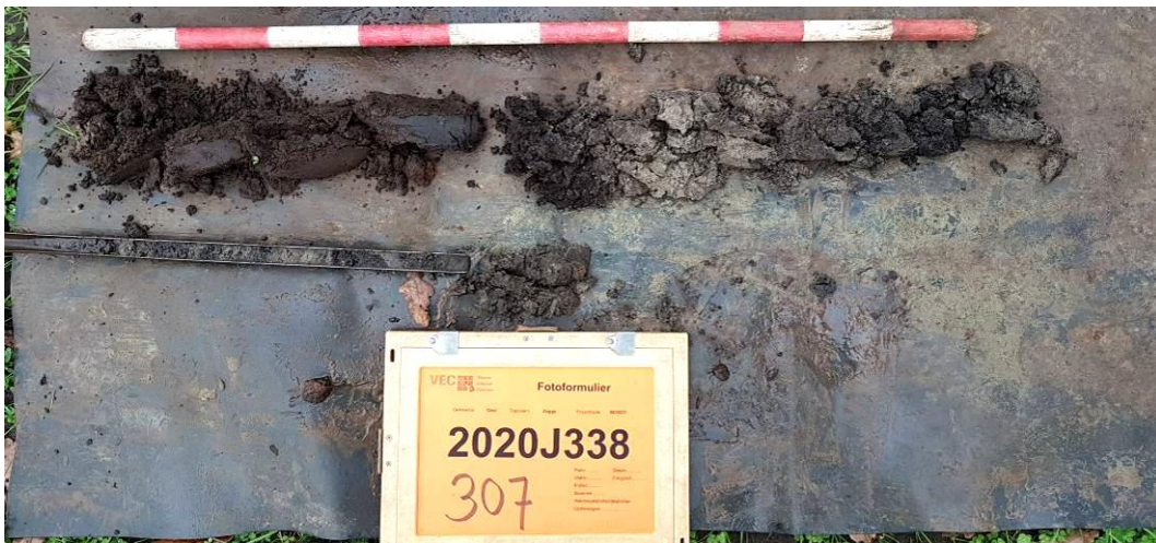
Afb. 26. Foto van boring 307 met veen op heterogeen humeus zand, uitgelegd per meter van linksboven naar rechtsonder.
