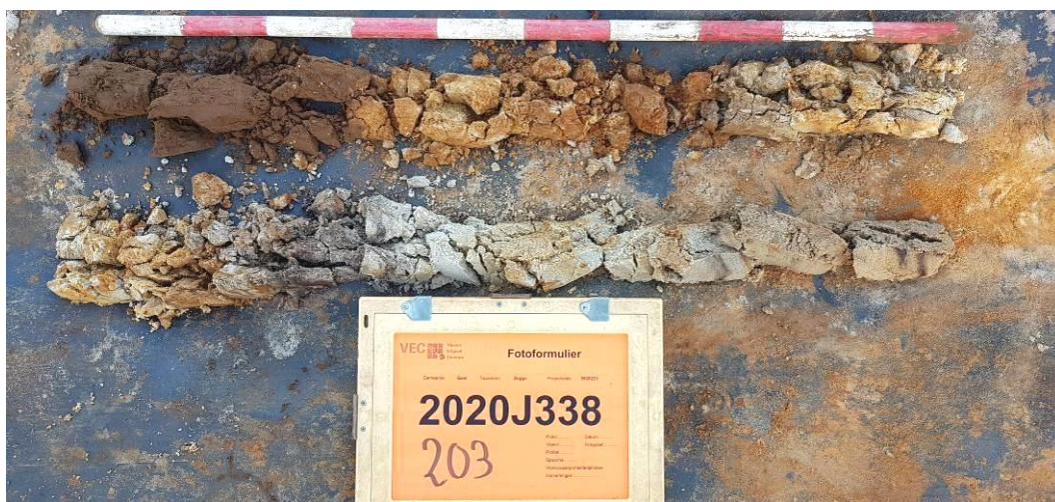
Afb. 35. Foto van boring 203 met twee Ahb-horizonten/vegetatielagen en detrituslaages aan de basis, uitgelegd per meter van linksboven naar rechtsonder.
