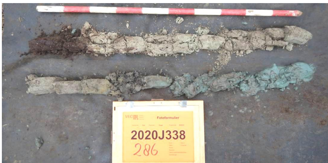
Afb. 42. Foto van boring 286 met een heldergroene zandlaag aan de basis onder een vegetatielaag en een geleidelijk afnemende concentratie humusvlekken in de bovenliggende lichtgrijze zandlaag, uitgelegd per meter van linksboven naar rechtsonder.
