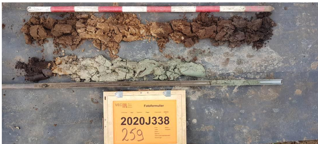
Afb. 28. Foto van boring 259 met afgedekte podzolbodem, uitgelegd per meter van linksboven naar rechtsonder.
