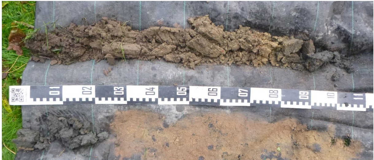
Figuur 40: Overzichtsfoto van boring BP4, uitgelegd van links naar rechts en van boven naar onder.
