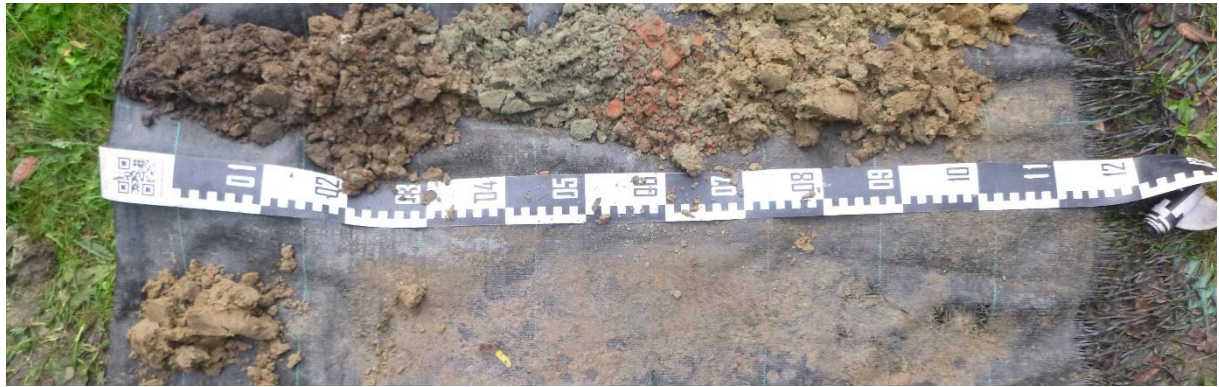
Figuur 36: Overzichtsfoto van boring BP1, uitgelegd van links naar rechts en van boven naar onder.
