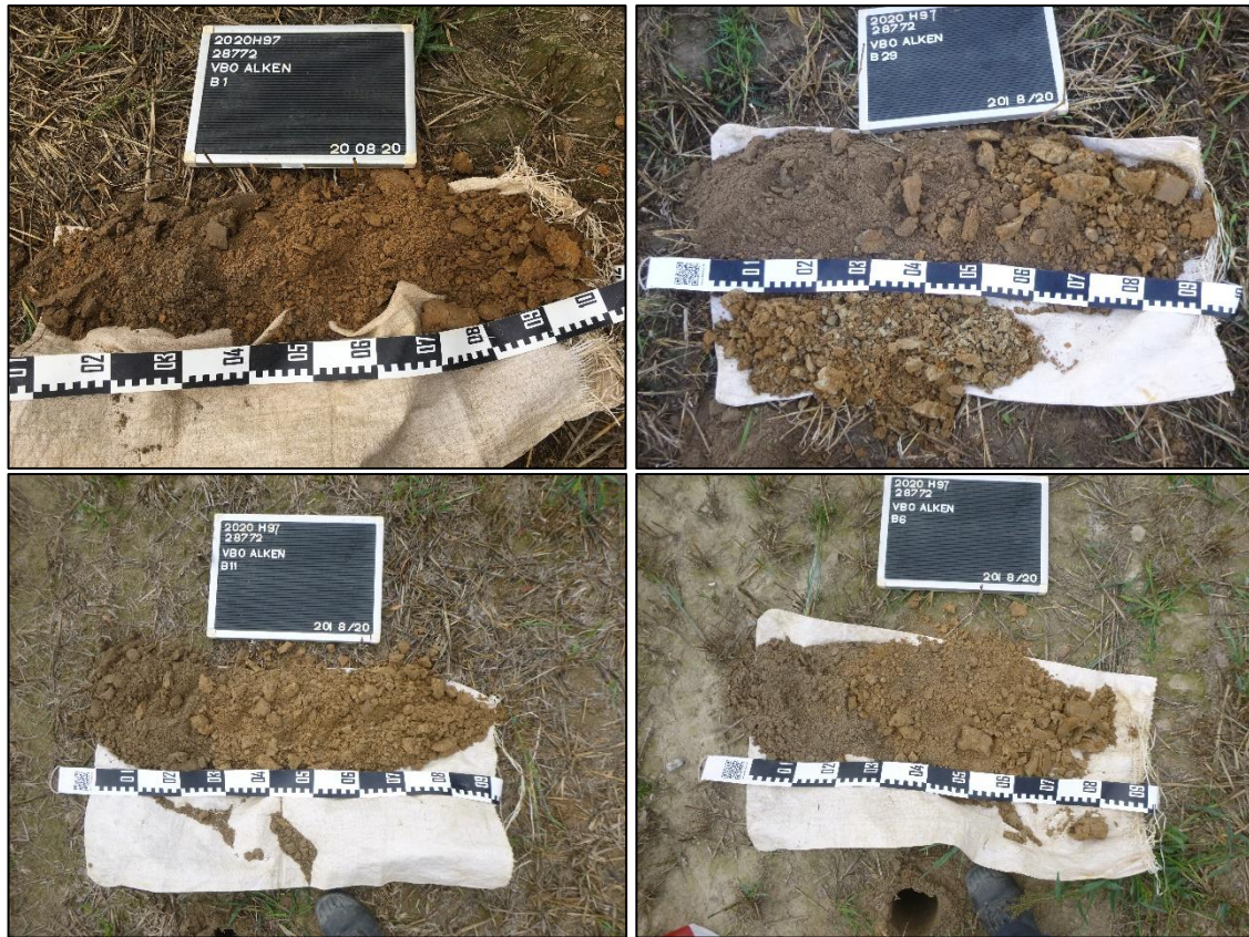
Figuur 16: Boorprofielen ter illustratie van de aangetroffen bodemopbouw: boring 1 (linksboven; Ap-Bt-C), boring 29 (rechtsboven; Ap-Bt-C-Tertiair), boring 7 (linksonder; Ap-Bt-C-Tertiair) en boring 6 (rechtsonder; Ap-C-Tertiair) (ABO nv 2020).
