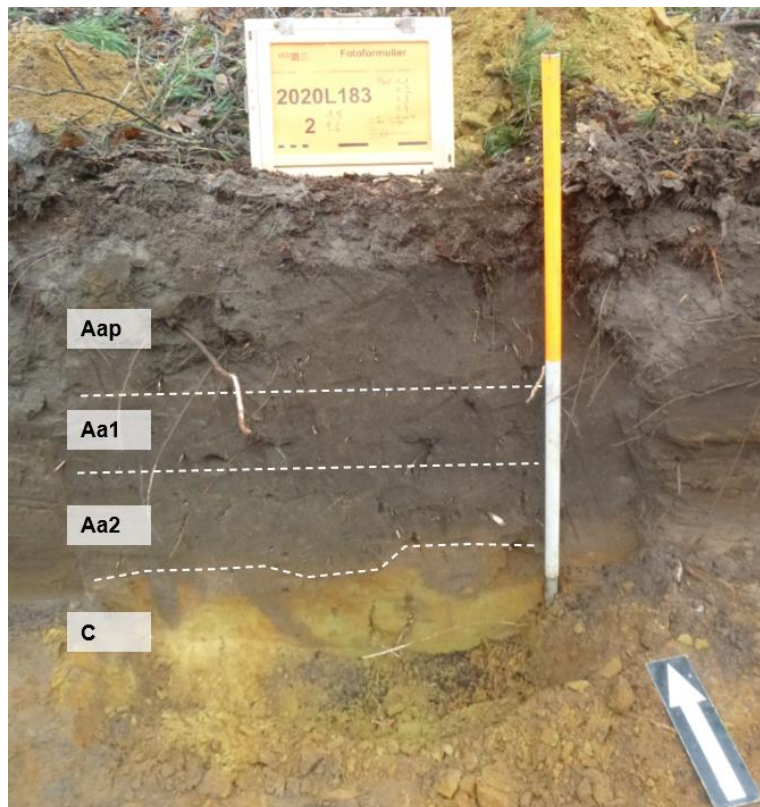
Afb. 20. Profiel 1.6 met aanduiding van de aangetroffen bodemhorizonten.
