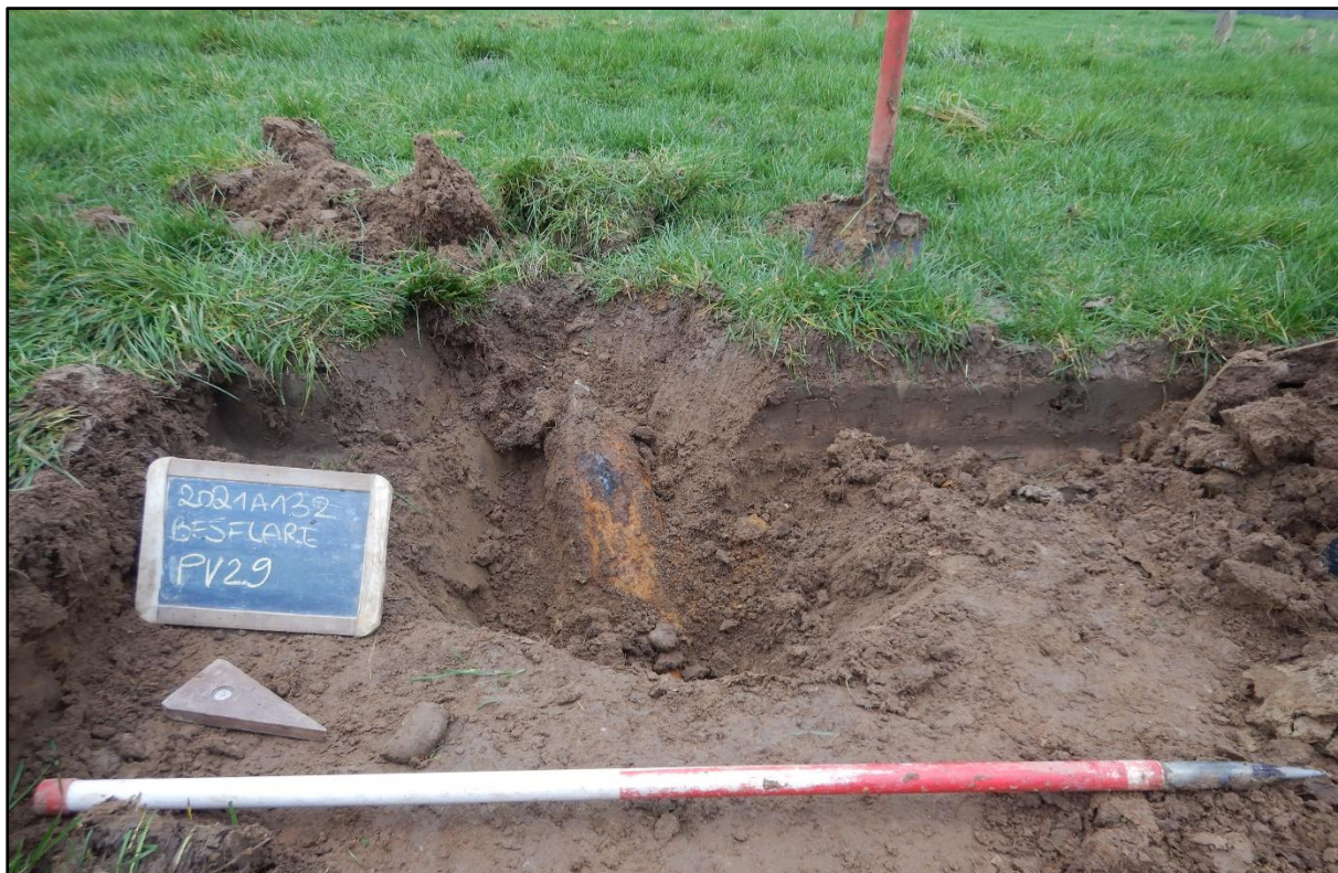
Figuur 11 Handmatige voorcontrol met schop van een anomalie, gevolgd door machinale gedeeltelijke vrij legging (PV29 – sleuf 11 – Britse 8inch); merk duidelijk de ondiepe ligging van het explosief op, vlak onder de graszoden.
