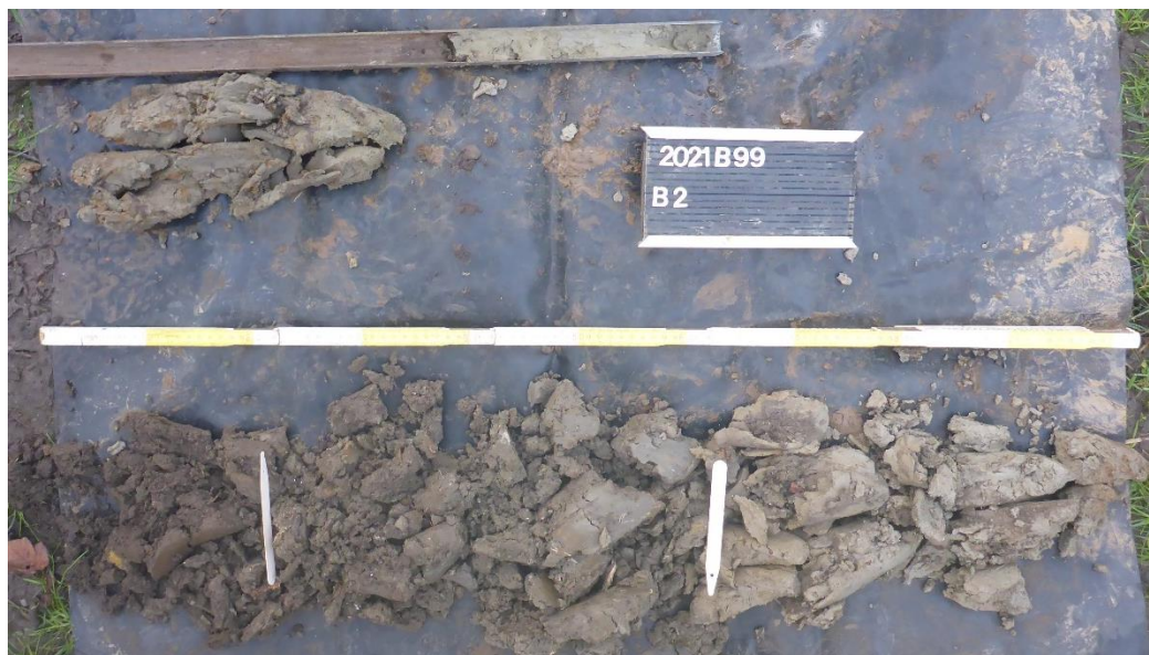
Figuur 5: Boring 2 met antropogeen pakket in horizonten 1 en 2 en mariene Holocene afzettingen in horizont 3.
