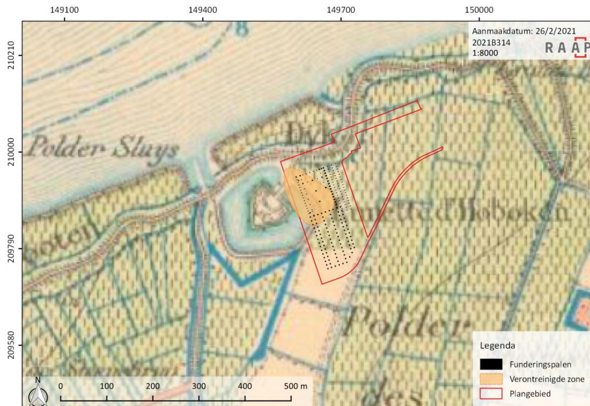
Figuur 25. Synthesekaart: voorziene funderingspalen en de verontreinigde zone geprojecteerd op de topografische kaart uit 1886 (bron: NGI, 2018).
