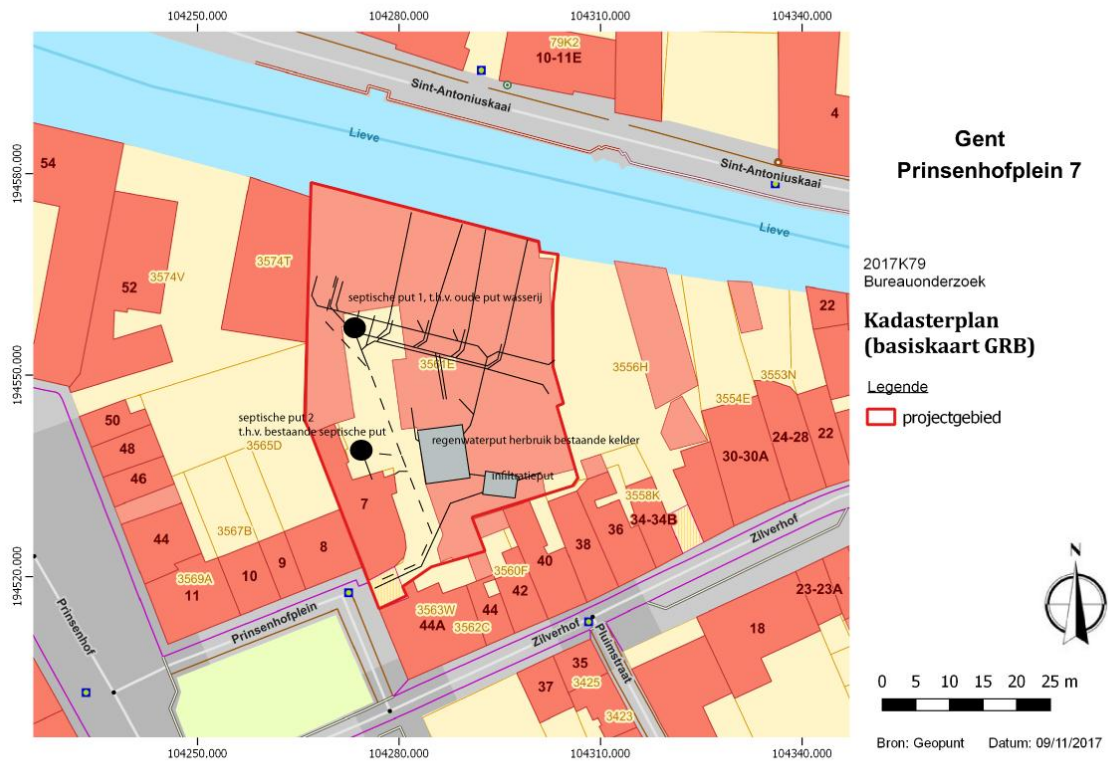
Figuur 22 Projectie van de geplande riolering en putten op de GRB-basiskaart. (bron: geopunt)
