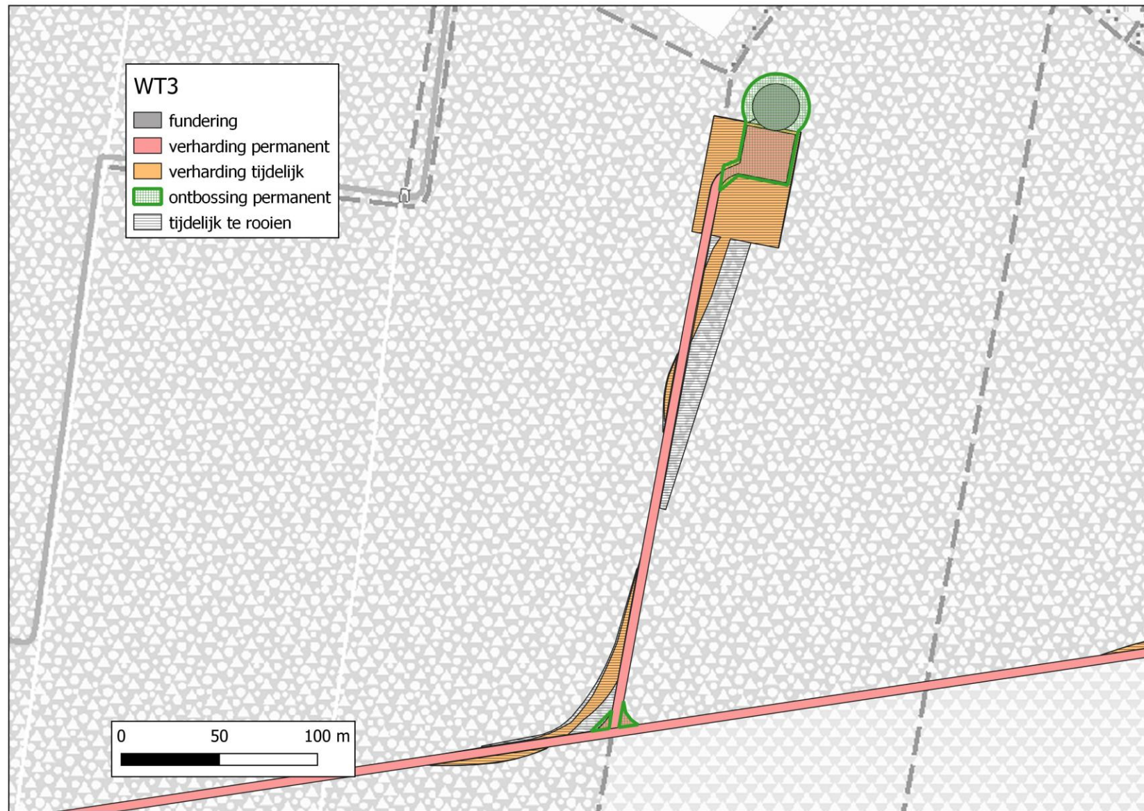
Afb. 13. Geplande werken windturbine 3.
