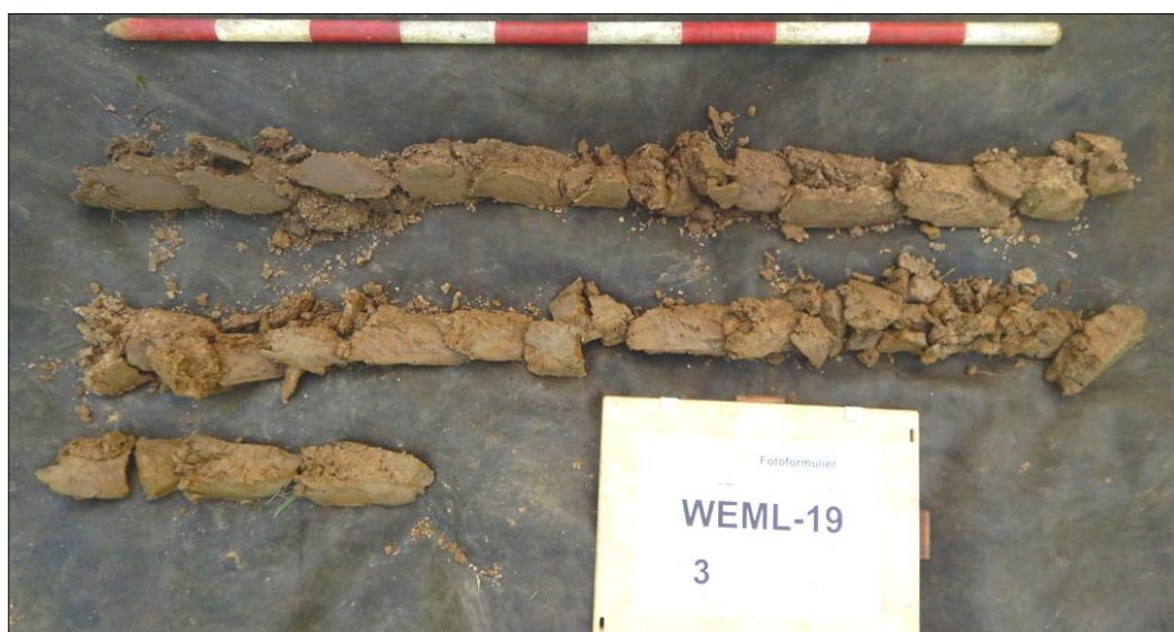
Afb. 10. Boring 3 met holocene colluvium op pleistoceen colluvium op pleistocene löss (Ap-C1-C2 profielopbouw).
