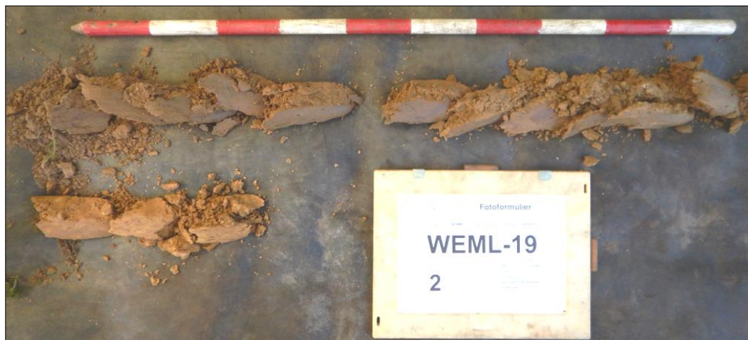
Afb. 9. Basisprofiel in boring 2, intacte textuur-B bodem met een Ap-E-Bt-BC-C profielopbouw in leem (löss).
