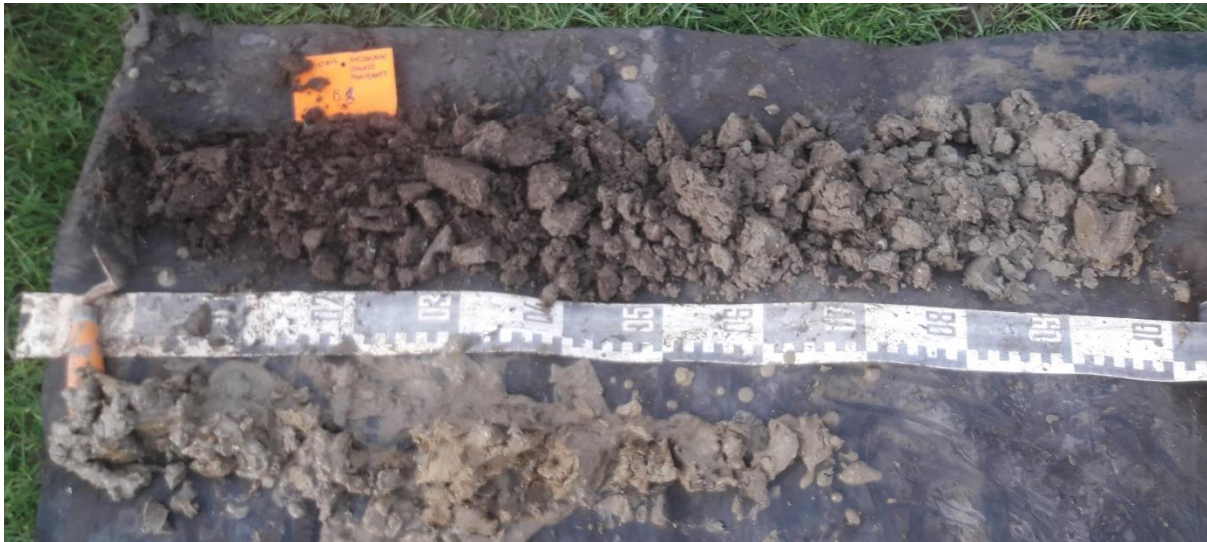
Figuur 5 : Boring 2, van 0 (linksboven) naar 170 cm (rechtsonder) beneden het maaiveld.
