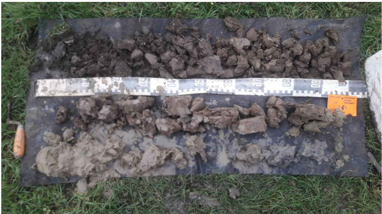
Figuur 6 : Boring 4, van 0 (linksboven) naar 320 cm (rechtsonder) beneden het maaiveld.
