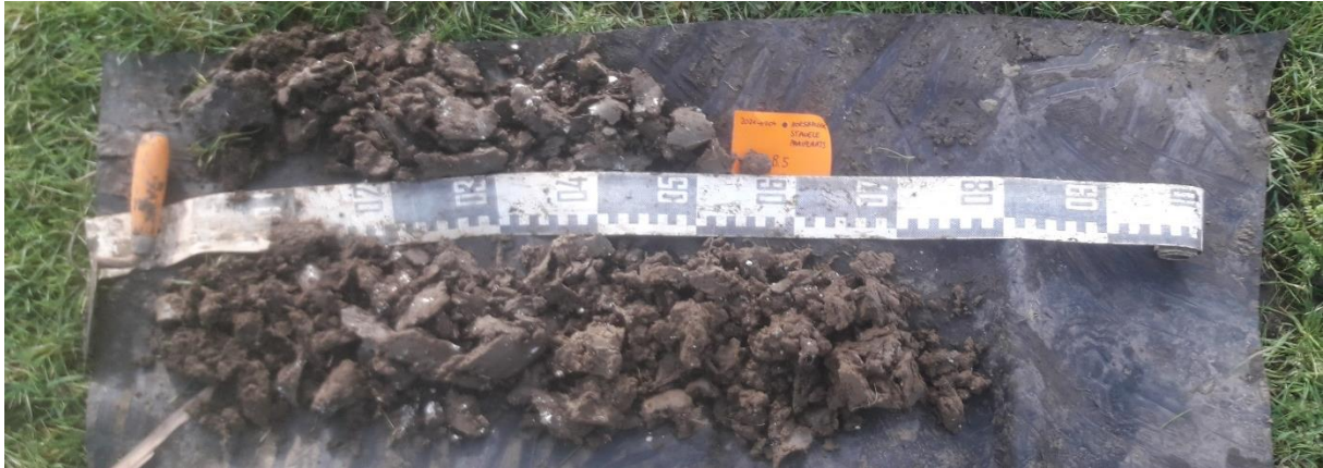
Figuur 7 : Boring 5A (boven), van 0 (links) naar 50 cm (rechts) beneden het maaiveld. Boring 5B (onder), van 0 (links) naar 80 cm (rechts) beneden het maaiveld.
