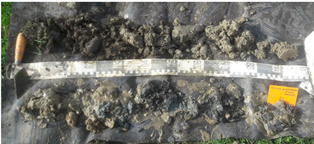
Figuur 8 : Boring 6, van 0 (linksboven) naar 220 cm (rechtsonder) beneden het maaiveld.
