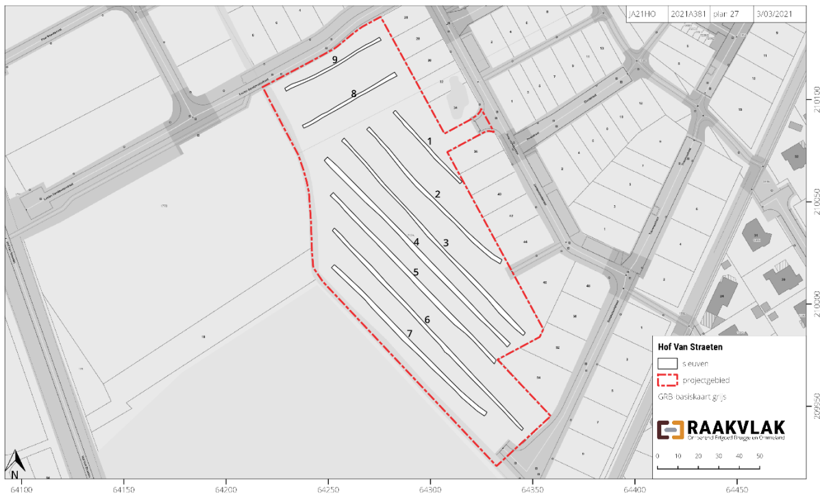
Figuur 30: Inplanting van de uitgevoerde sleuven
