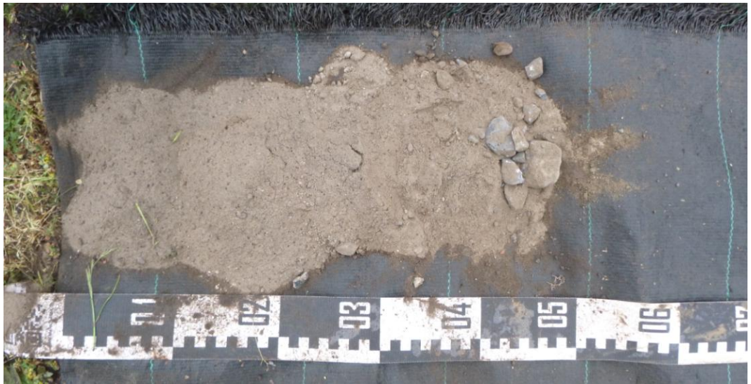
Afb. 18. Foto van boring BP2, uitgelegd van links naar rechts.
