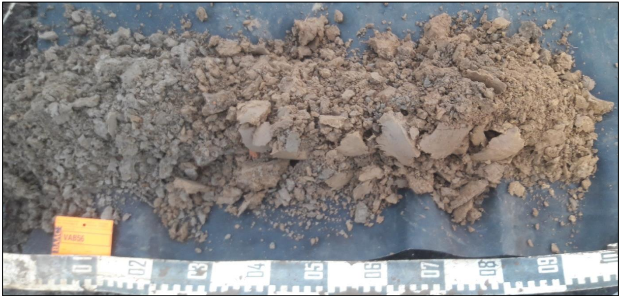
Figuur 18: VAB56 met een Ap-AC-Bt-C bodemopbouw
