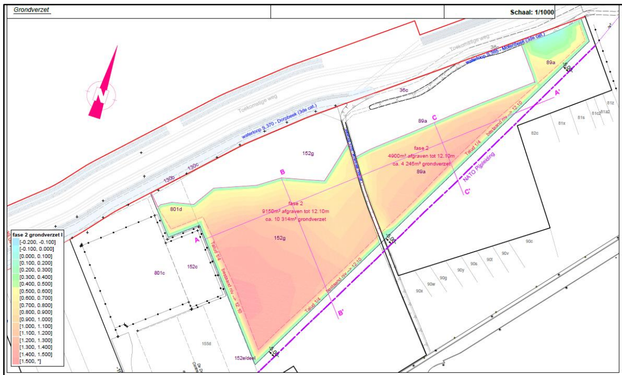
Figuur 3 Uitsnede uit het ontwerpplan, initiële grondwerken (bron: initiatiefnemer).
