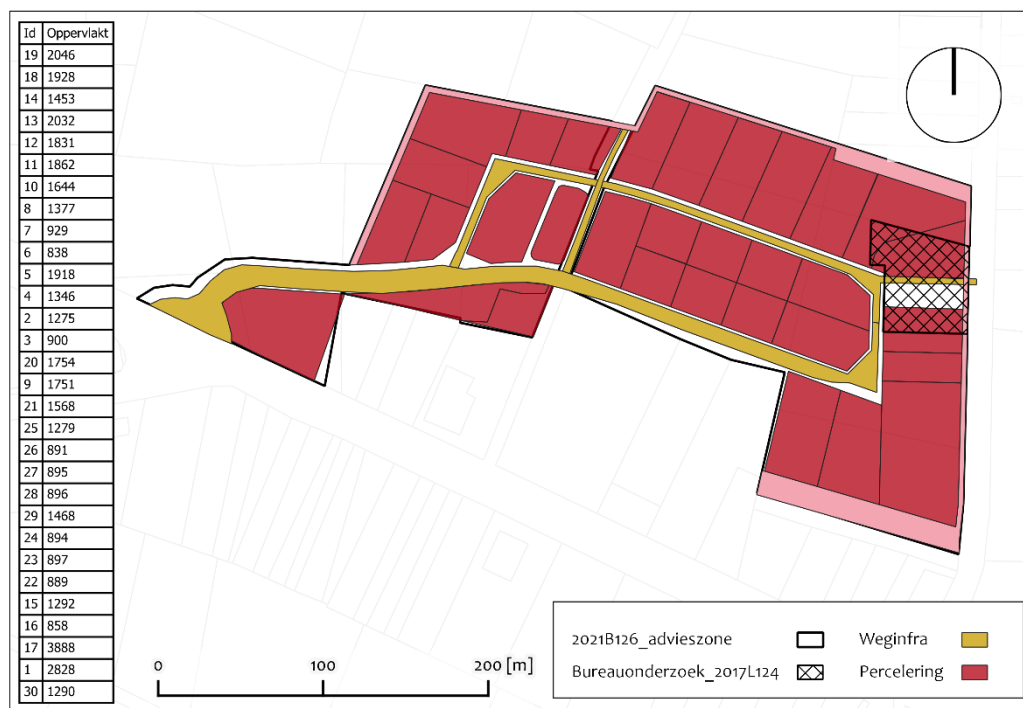
Figuur 4: Vereenvoudigde weergave ontwerpplan geprojecteerd op actueel kadaster, waarbij de bedrijfskavels en de toekomstige wegen in de in het vooronderzoek onderzochte advieszone vormen; met aanduiding simultaan aan te leggen pompstation [Aquafin] zoals beschreven in BO 2017L124 [© AIV]
