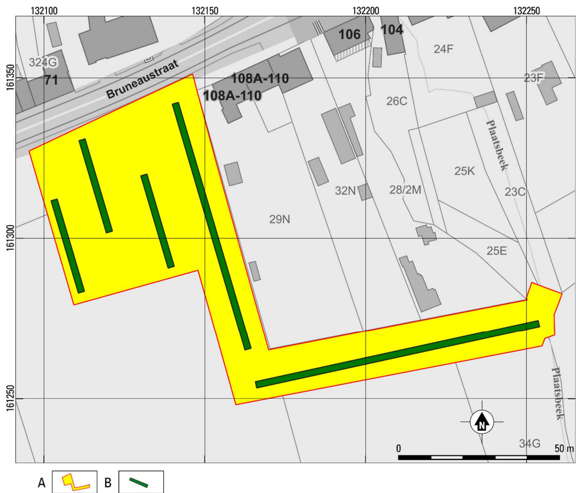
Fig. 4. Gooik – Afkoppeling Plaatsbeek te Kester (23.235). Indicatie van de geplande proefsleuven. A onderzoeksgebied; B proefsleuf.
