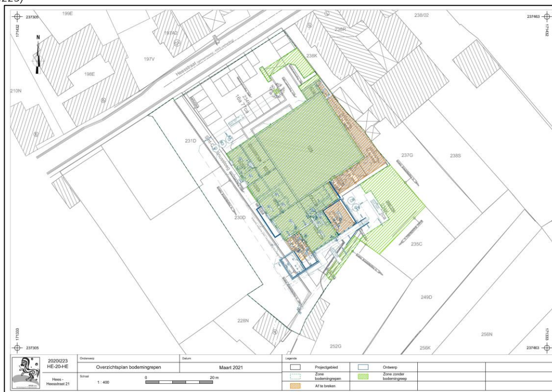
Afb. 4.2: Overzichtsplan bodemingrepen met te behouden bebouwing, groenzones, speelzone en pad in het groen en af te breken bebouwing in het bruin. De bestaande toestand (BT) staat in het grijs aangeduid, de ontworpen toestand in het blauw en de geplande nutsleidingen in het paars (Bron: Wim Lormans Architect, digitaal plan, dd 16/10/2020, aanmaatschaal 1.400, 2020I223).
