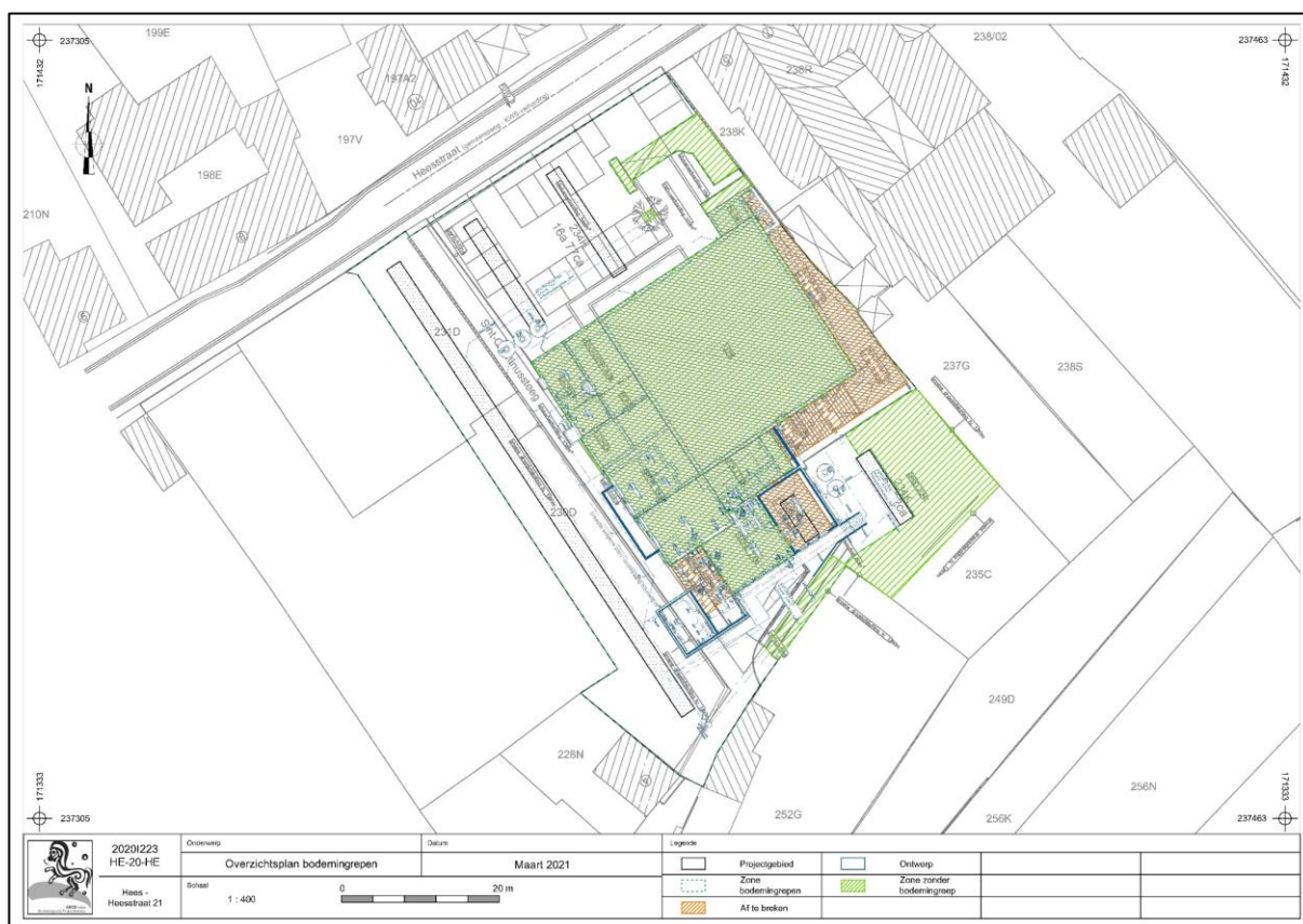
Afb. 34: Overzichtsplan bodemingrepen met te behouden bebouwing, groenzones, speelzone en pad in het groen en af te breken bebouwing in het bruin. De bestaande toestand (BT) staat in het grijs aangeduid, de ontworpen toestand in het blauw en de geplande nutsleidingen in het paars (Bron: Wim Lormans Architect, digitaal plan, dd 16/10/2020, aanmaakschaal 1.400, 2020I223).
