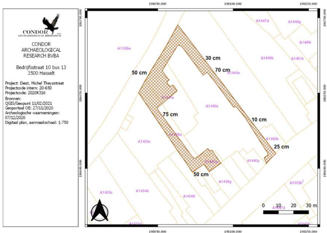
Afbeelding 4.3.1: Overzichtplan met de minimale dikte van de bufferzone tussen het hoogste archeologisch relevante niveau en de onderzijde van de toekomstige verstoring. De toekomstige ontgravingsdiepte bedraagt tussen de 2 en 32 cm. We zijn gemakkelijksheidshalve uitgegaan van deze 32 cm.
